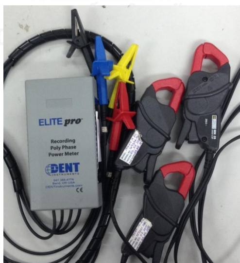
รูปที่ 5.10 แสดงเครื่องบันทึกพลังงานไฟฟ้า
