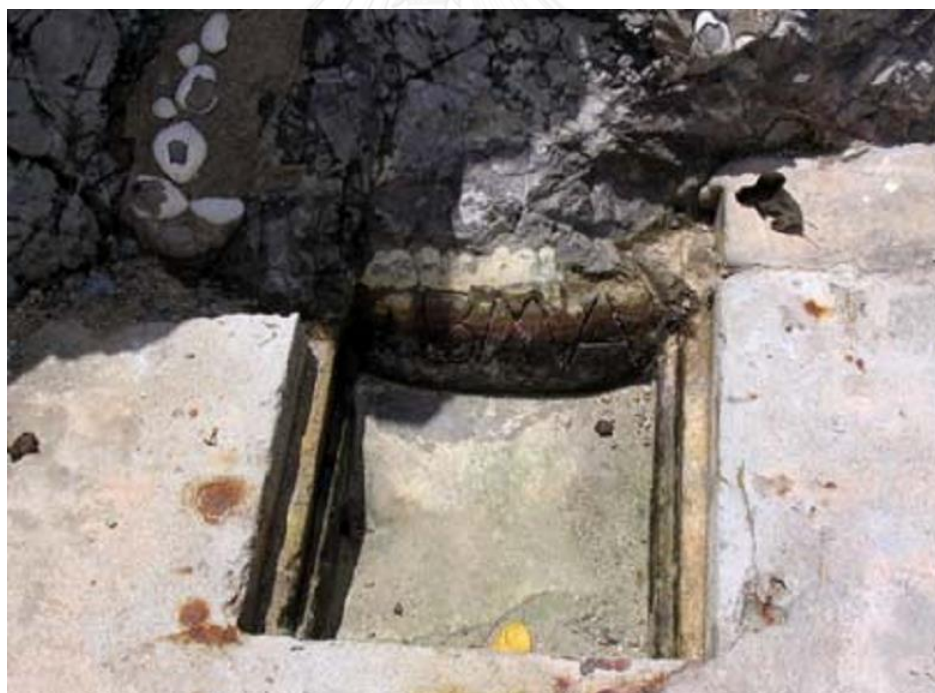
รูปที่ 3 หมุด BMA หมุดอ้างอิงทางดิ่งหมุดแรก ที่ ต.เกาะหลัก อ.เมือง จ.ประจวบคีรีขันธ์
