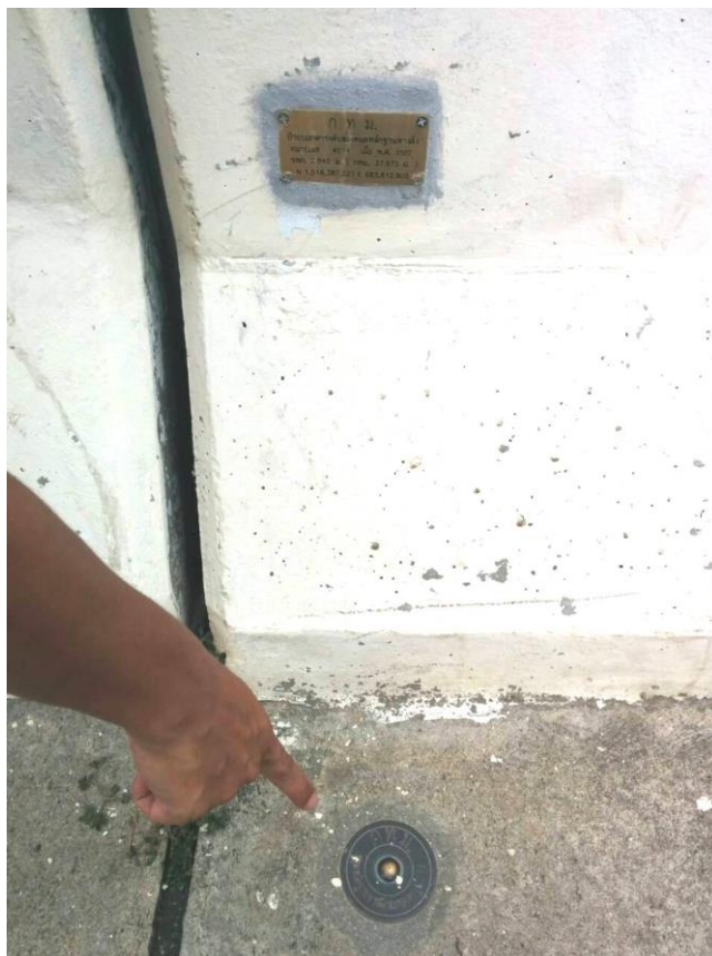
รูปที่ 24 หมุดควบคุมทางดิ่งของกรุงเทพมหานคร
