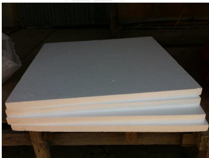
ภาพที่ 2-5 แผ่นฉนวนกันความร้อน EPS foam ที่ใช้ในการศึกษา
