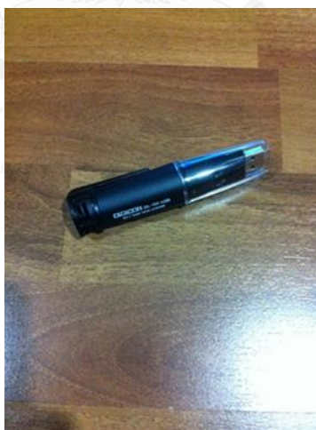
ภาพที่ 3-16 เครื่องบันทึกอุณหภูมิ USB Data Logger DL-TH-USB
