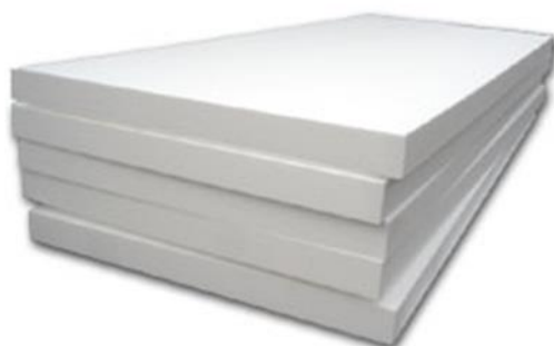
ภาพที่ 3-3 EPS foam ชนิด F-Grade ความหนาแน่น 1.25 ปอนด์ต่อลูกบาศก์ฟุต ความหนา 2 นิ้ว สำหรับกรุทับแผ่นยิปซัมบอร์ด [9]
