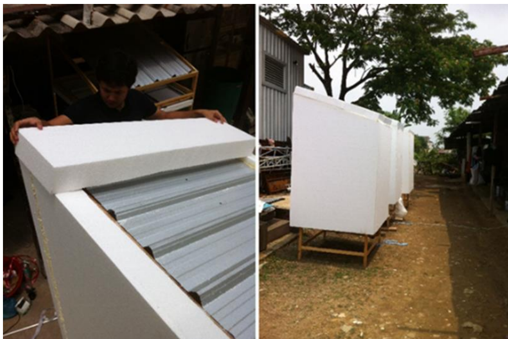
ภาพที่ 3-22 แสดงการประกอบโมเดลจำลอง (ซ้าย) และโมเดลจำลองที่ประกอบเสร็จ (ขวา)
