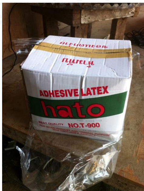
ภาพที่ 3-4 กาวขาวสำหรับยึดติดแผ่นยิปซัมบอร์ดกับฉนวนกันความร้อน EPS foam
