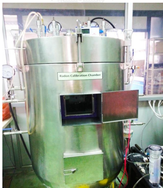
รูปภาพ 3.7 แสดงภาพการบันทึกรอยอนุภาคแอลฟาจากเรดอนในเรดอนแชมเบอร์
