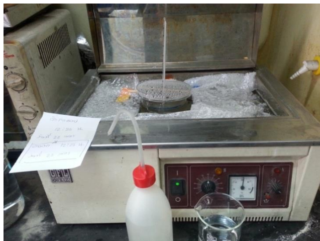
รูปภาพ 3.4 แสดงภาพการกัดรอยแผ่นซีดีด้วยสารละลาย PEW ที่อุณหภูมิ 60 องศาเซลเซียส
