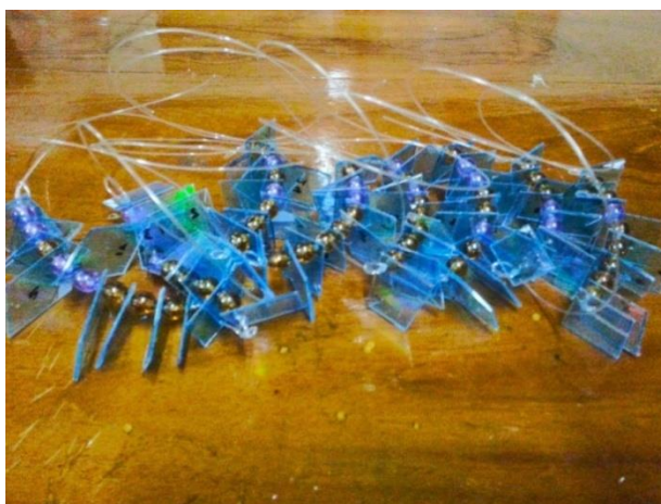
รูปภาพ 3.6 แผ่นซีดีที่เตรียมไว้สำหรับนำไปบันทึกรอยอนุภาค
