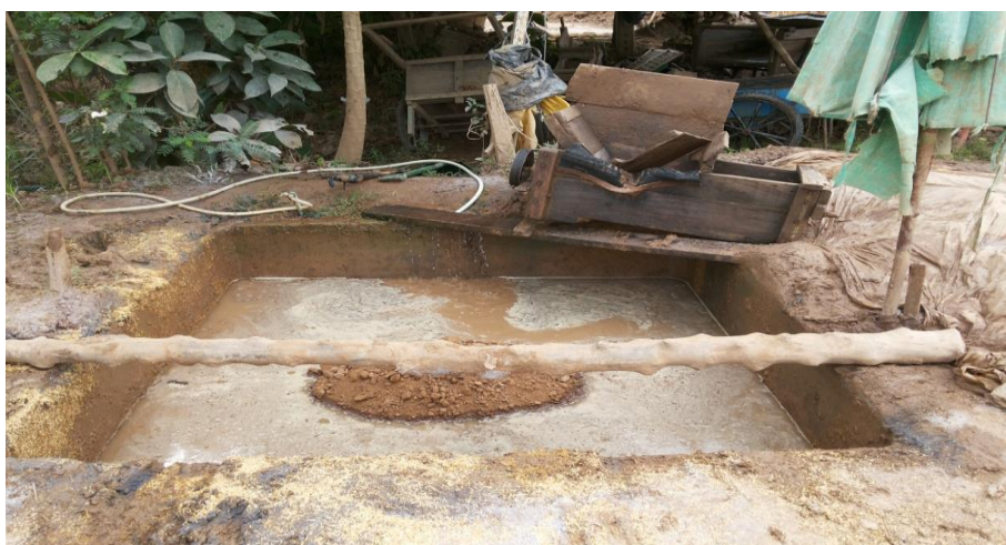
ภาพที่ 4.9 การผสมดิน แกลบ และน้ำในบ่อผสม
