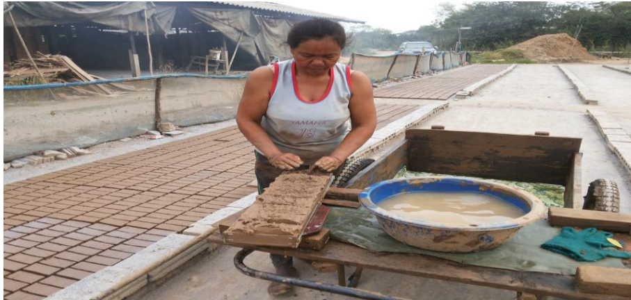
ภาพที่ 4.10 การอัดดินผสมแกลบเข้าในแบบพิมพ์
