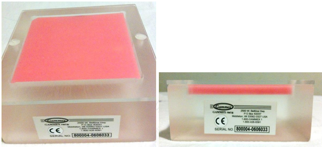
รูปที่ 4-2 หุ่นจำลองเนื้อเยื่อเต้านม Gammex Mammographic Accreditation Phantom Model 156
