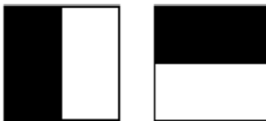
รูปที่ 3-8 Haar Wavelet Filter ที่ใช้ในการคำนวณหา Haar Wavelet response ในแนวแกน x (ซ้าย) และแนวแกน y (ขวา) [47]
