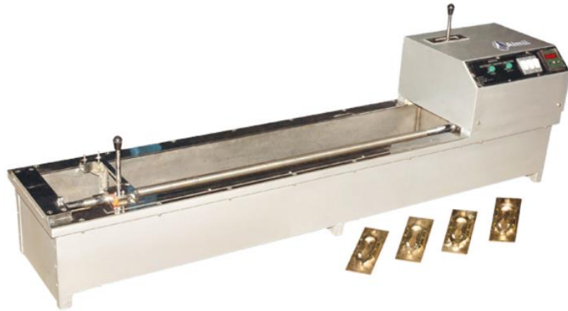
รูปที่ 19 แสดงเครื่องวัดค่าการยืดหยุ่นกลับ
