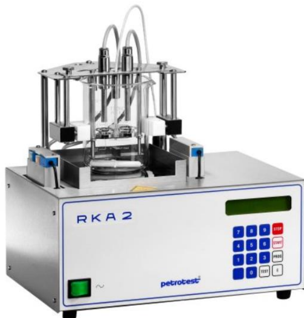
รูปที่ 18 แสดงเครื่องวัดอุณหภูมิจุดอ่อนตัว แหล่งที่มา : http://en.petrotech.ru/en/equipment
