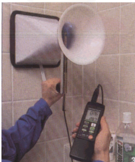
รูปภาพที่ 3.28 แสดงการวัดความเร็วลมที่ช่องด้วยfunnel ที่หน้างานจริง( TESTO: The Informative Catalogue :P157)
