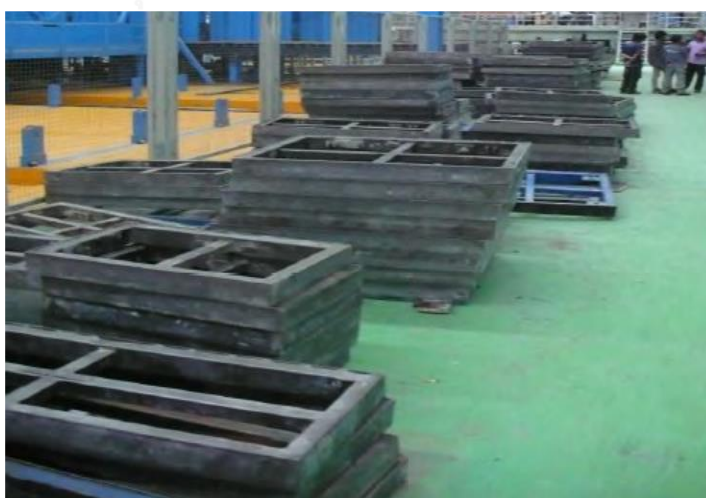
รูปที่ 5.2 การกองเก็บของช่องเปิดหน้าต่างที่มีจำนวนมากมีรูปร่างใกล้เคียงกัน
