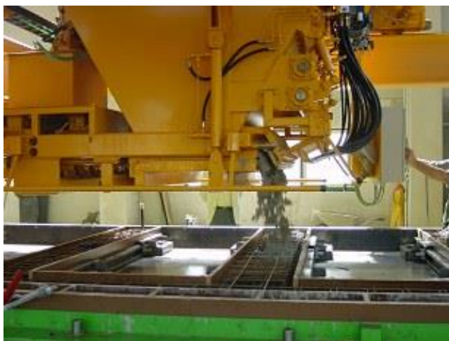
รูปที่ 2.10 ขั้นตอนการเทคอนกรีต (ที่มา : http://www.ebawe.com )
