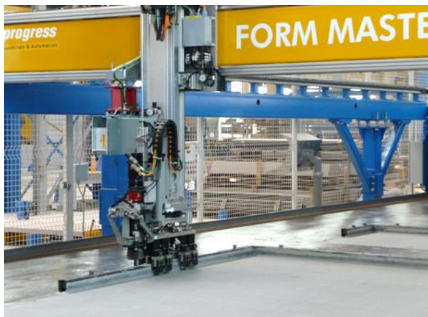
รูปที่ 2.8 ขั้นตอนการวางเหล็กกันแบบหล่อ (ที่มา : http://www.ebawe.com )
