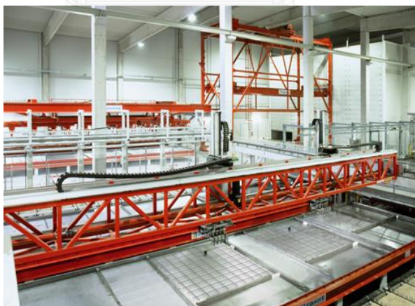
รูปที่ 2.9 ขั้นตอนการวางเหล็กเสริม (ที่มา : http://www.ebawe.com )
