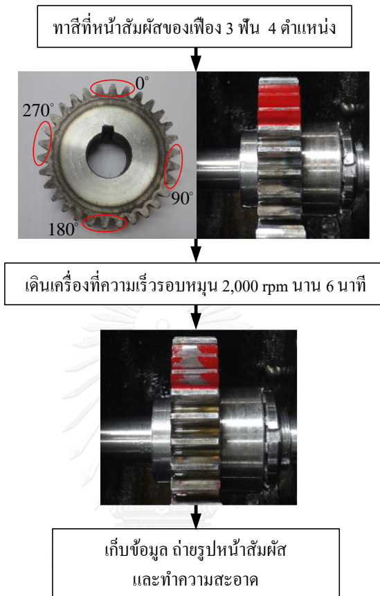
รูปที่ 5.1 ขั้นตอนการทาสีหน้าสัมผัสฟันเฟือง
