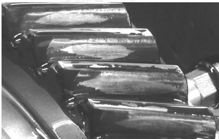
รูปที่ 5.16 ผลการทดสอบการสัมผัสของฟันเฟืองเฉียงที่ทำ lead crowning 5 micron และ profile crowning 3 micron
