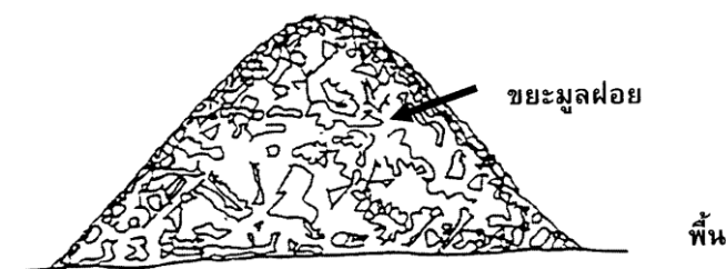
รูปที่ 2.2 ลักษณะการกองขยะมูลฝอยให้เป็นรูปกรวยคว่ำ
