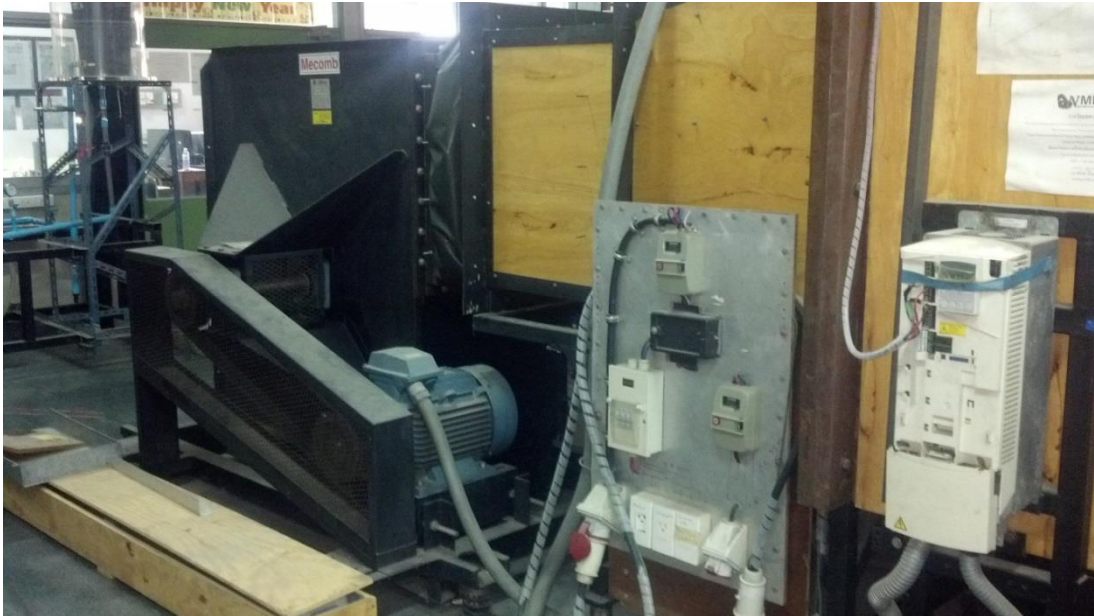
รูปที่ 4.3 พัดลมหอยโขงแบบ backward curve airfoil blades
