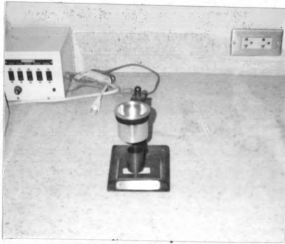
รูปที่ ข.6 เครื่องวัดอัตราการไหลตัวของอนุภาคแบบฮอลล์
