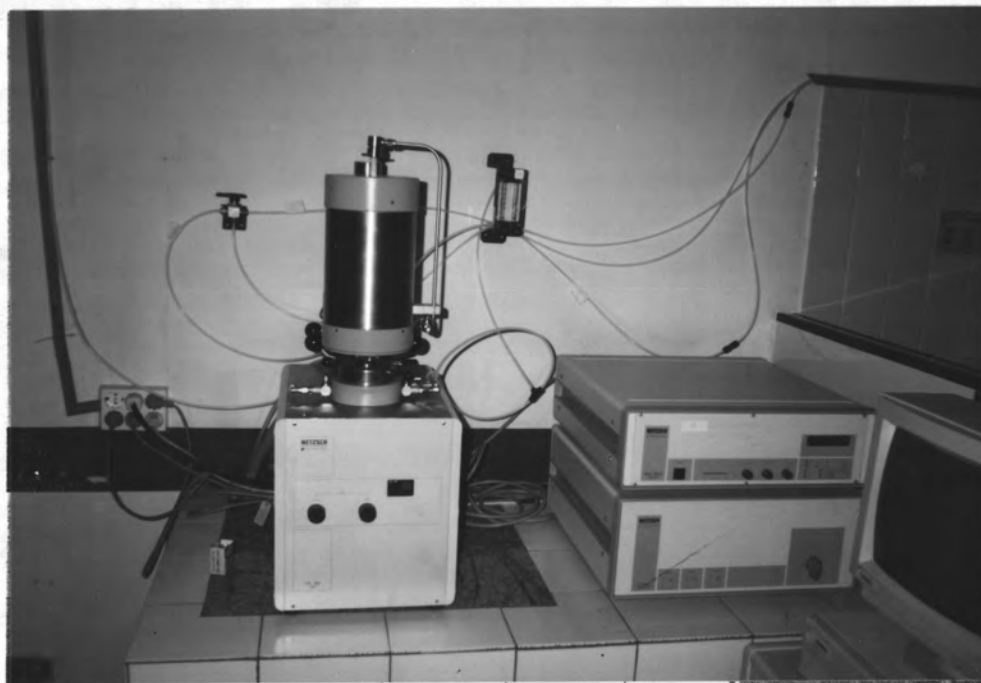
รูปที่ ข.9 เครื่องวิเคราะห์สมบัติทางความร้อนของวัสดุ
