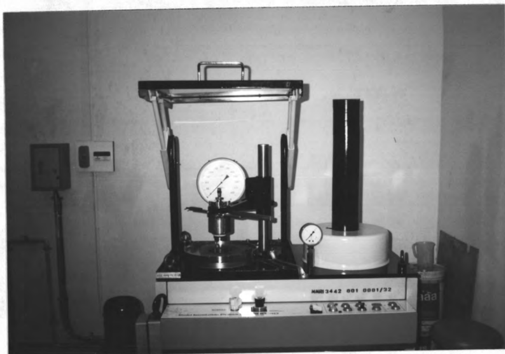
รูปที่ ข.11 เครื่องขึ้นรูปชนิดให้ความดันเท่ากันทุกทิศทางแบบแม่เฟาหรือ โกลด์ไฮดรอสแตติก เพรสซึ่งแบบเบียด
