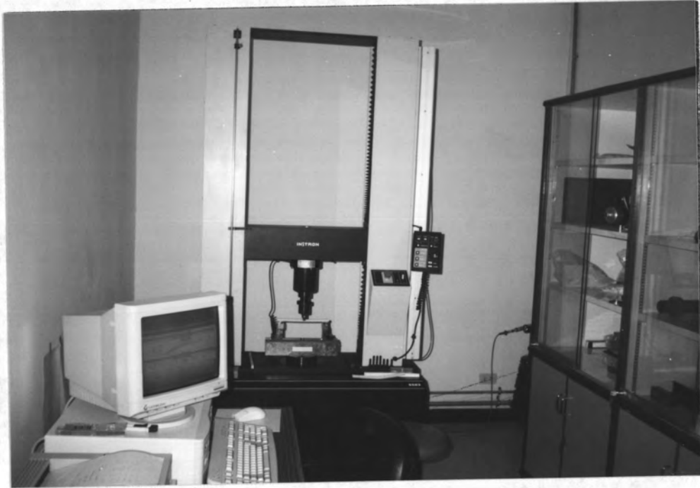
รูปที่ ข.13 เครื่องทดสอบแรงดึงและแรงกดของวัสดุ
