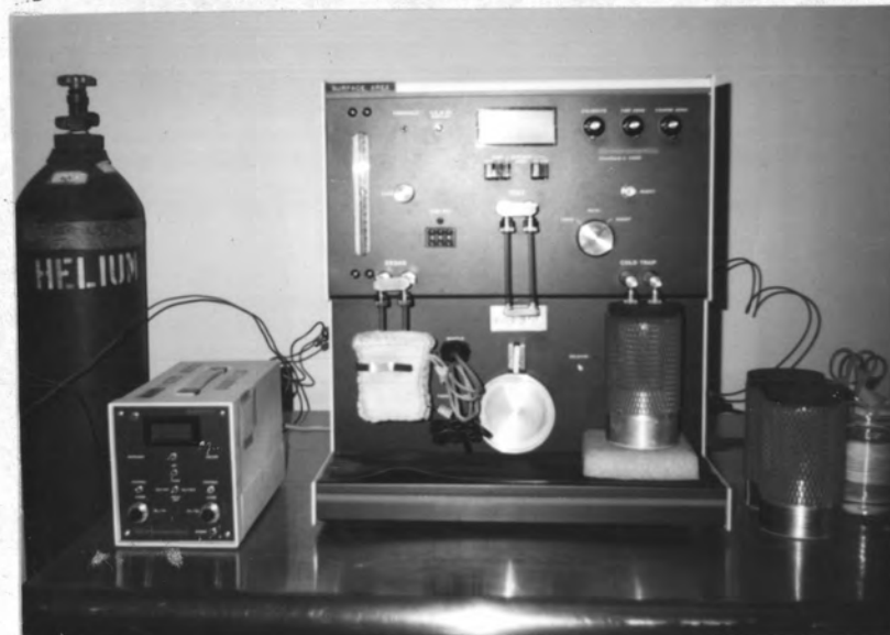
รูปที่ ๕.๕ เครื่องวัดขนาดพื้นที่ผิวของอนุภาค
