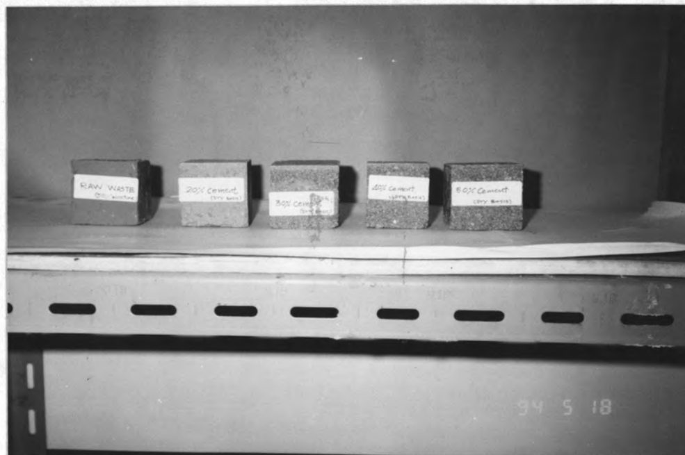
ก้อนตัวอย่างที่ทำให้แข็งตัวเป็นก้อน
