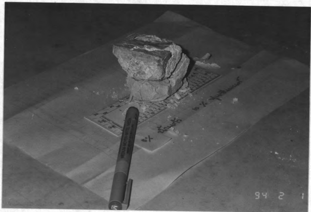
ก้อนตัวอย่างที่ผสมกับปูนซีเมนต์ร้อยละ 10 (น้ำหนักเปียก)
