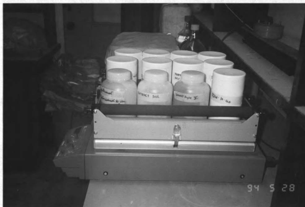
เครื่องเขย่าในการทดสอบการสกัดสาร
