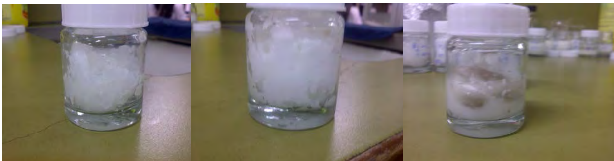
รูปที่ 5 ครีม Brij™ 72 และ Brij™ 721 10% ที่มีน้ำมันมะพร้าว 65% (ซ้าย : stiffening agent 10%, กลาง : stiffening agent 5%, ขวา : stiffening agent 2.5%)
