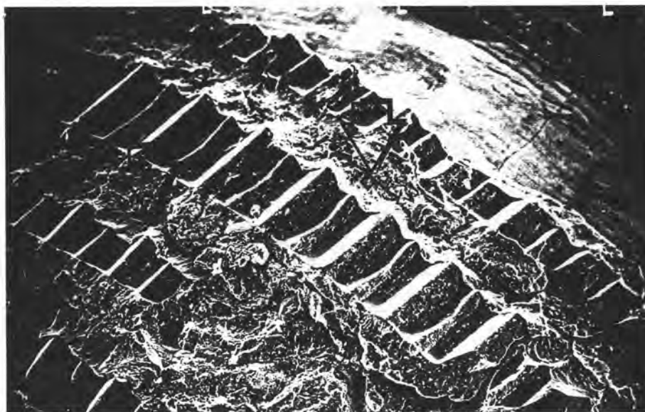
รูปที่ 52 ภาพถ่ายกล้องจุลทรรศน์อิเล็กตรอนแบบส่องกราดแสดงรอยร้าว (Crack) (ศรชี้) ที่พบในส่วนของวัสดุยึดที่ติดอยู่กับฐานแบริกเก็ตแบบ Dynalock (ก.) และในส่วนของวัสดุยึดบนผิวเคลือบฟันที่ติดด้วยแบริกเก็ตนี้ (ข.)
