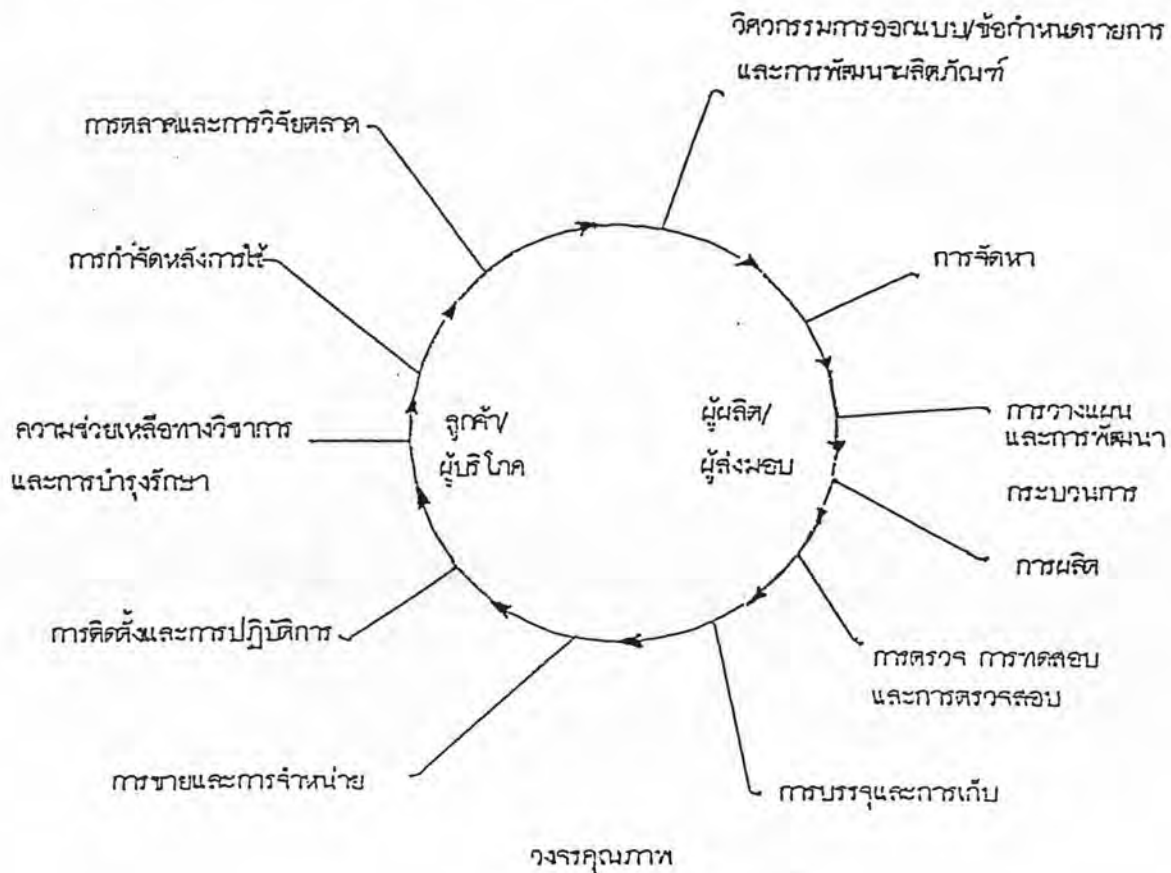
รูปที่ 3.1 วงจรคุณภาพแสดงลำดับขั้นตอนปฏิบัติต่าง ๆ ในการทำงานเพื่อการควบคุมคุณภาพ
