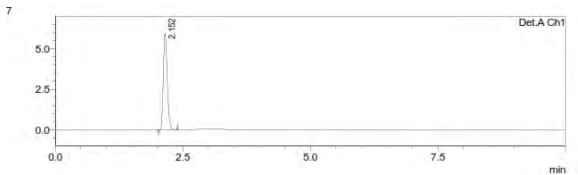
รูปที่ 1 แสดงโครมาโทแกรมของสารละลาย Uracil ความเข้มข้น 0.006 mg/ml
