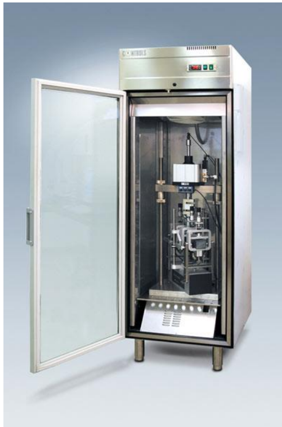
รูปที่ 4.7 เครื่องทดสอบ universal testing machine ที่อยู่ในตู้ควบคุมอุณหภูมิ
