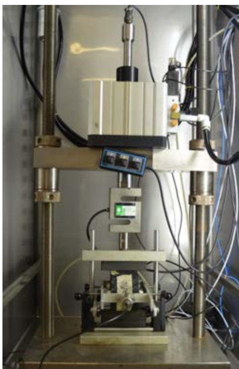
รูปที่ 4.10 การติดตั้งตัวอย่างเพื่อให้ในการทดสอบค่าโมดูลัสคืนตัวของแอสฟัลติกคอนกรีต
