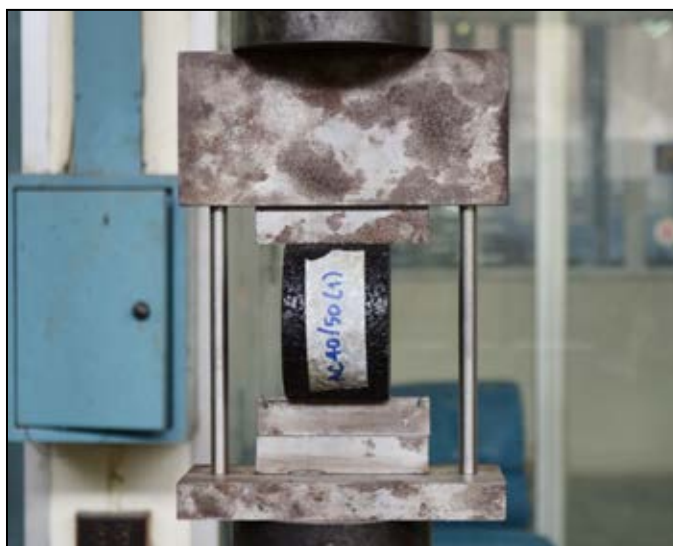
รูปที่ 4.9 การติดตั้งตัวอย่างเพื่อให้ในการทดสอบค่าความต้านทานต่อแรงดึงทางอ้อม
