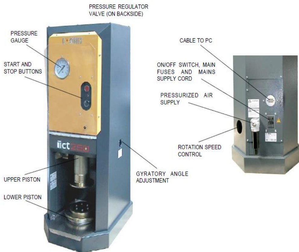
รูปที่ 4.3 เครื่องบดอัดไจราทอรีในระบบซูเปอร์เพฟ (superpave gyratory compactor)
