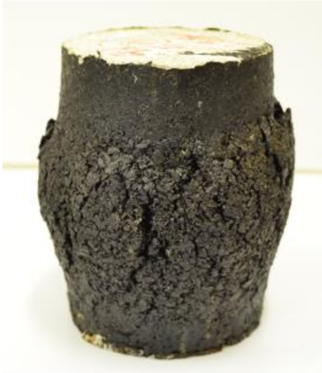
รูปที่ 5.10 ลักษณะตัวอย่างเมื่อเกิดการวิบัติแบบการยุบตัวถาวร
