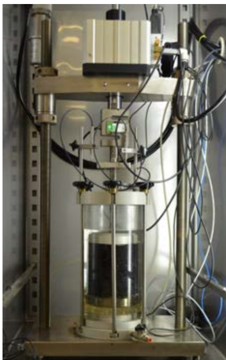
รูปที่ 4.8 แสดงการติดตั้งตัวอย่างเพื่อการทดสอบแรงอัดแบบปราศจากแรงดันด้านข้าง
