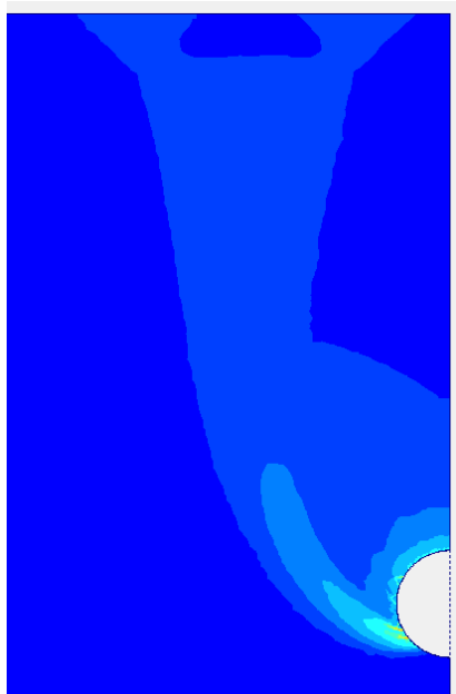
ภาพที่ 6.15 รูปแบบการวิบัติของลักษณะความเครียดเฉือนที่เพิ่มขึ้น สำหรับกรณี C/D=5 , \gamma D/s_{u0}=5 และ \rho D/s_{u0}=1
