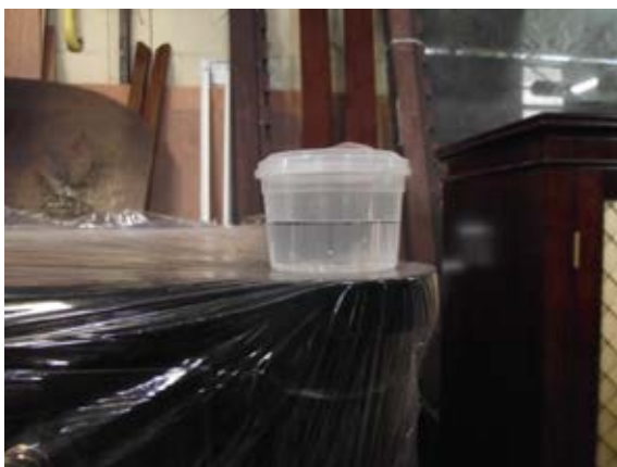
รูปที่ 4.4 อุปกรณ์การตรวจสอบระดับระนาบของชิ้นงาน
