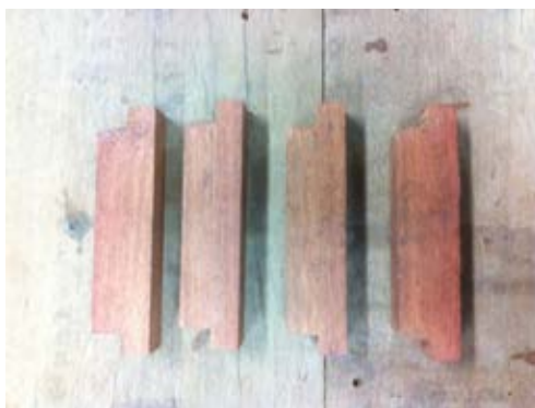
รูปที่ 4.8 จิกช่วยป้องกันความเสียหายขณะประกอบ
