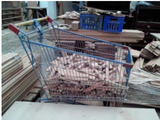
รูปที่ 4.3 รถเข็นช่วยรองรับชิ้นงานจากเครื่องไสอัตโนมัติ
