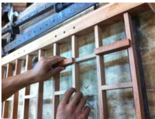
รูปที่ 4.9 ใส่จิกป้องกันก่อนประกอบชิ้นงาน
