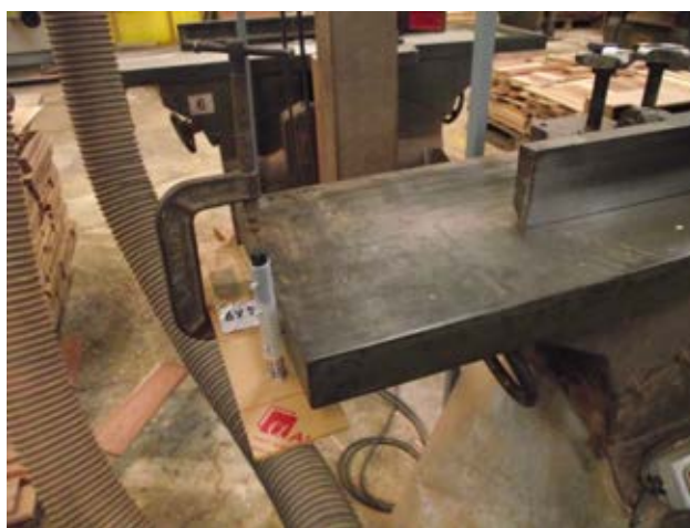
รูปที่ 4.1 การติดตั้งอุปกรณ์ขีดที่เครื่องเปิดหน้า
