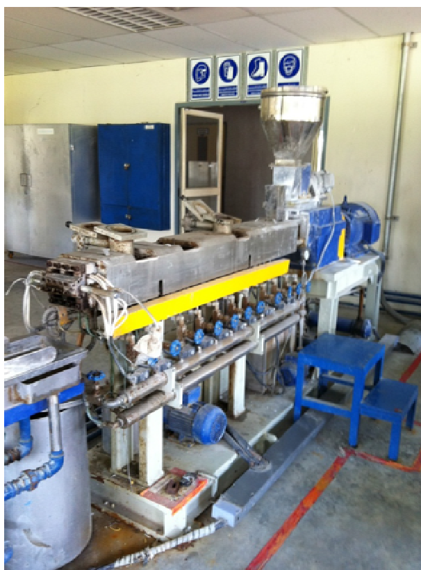
รูปที่ 3.2 เครื่องอัดรีดแบบสกรูคู่ (Twin screw Extruder; Nanjing SHJ-36)
