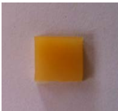
รูปที่ 3.8 ตัวอย่างชิ้นงานทดสอบหาปริมาณการเกิดปฏิกิริยาเชื่อมโยงโมเลกุล
