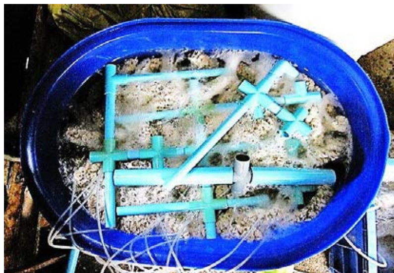
รูปที่ 3.6 ถังเตรียมและปรับสภาพตัวกรองชีวภาพในทริฟิเคชันในการศึกษาอัตราการบำบัดในทริฟิเคชันของไบโโคออร์ด์และหินพัมมิสบัด
