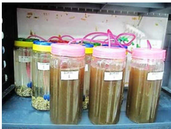
รูปที่ 3.17 การตรวจวัดอัตราการบำบัดไนโตรฟิเคชันในการศึกษาประสิทธิภาพของถังปฏิกรณ์ร่วมไนโตรฟิเคชัน-ดีไนโตรฟิเคชันในการบำบัดน้ำเสียจริงจากการเพาะเลี้ยงสัตว์น้ำ
