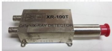
รูปที่ 3.2 หัววัดรังสี CdTL ขนาด 5x5 มิลลิเมตร
