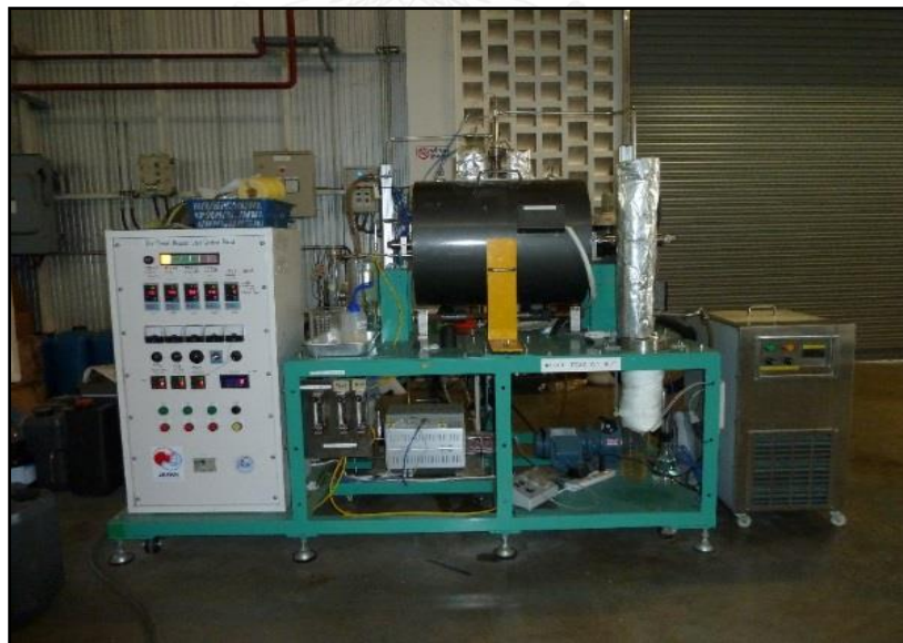
ภาพที่ 3.1 เครื่องปฏิกรณ์แบบต่อเนื่องขนาด 3 ลิตร
