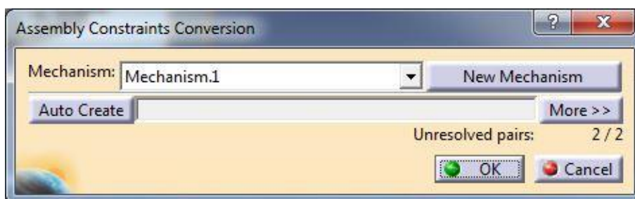
รูปที่ ง.21 ปุ่ม Auto Create บนแผง Assembly Constraint Conversion
