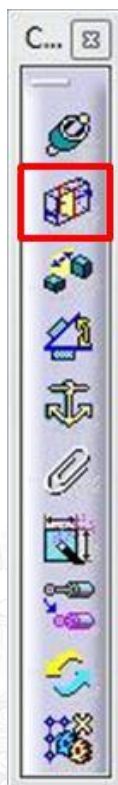
รูปที่ ง.17 ปุ่ม Contact Constraint บนแถบเครื่องมือ
