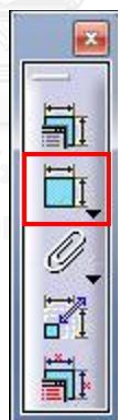
รูปที่ ง.7 ปุ่ม Constraint บนแถบเครื่องมือ
