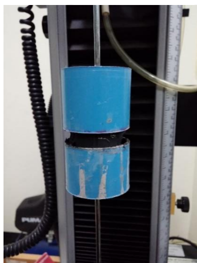
รูปที่ 3.4 ตัวอย่างสำหรับการทดสอบกำลังรับแรงดึงของแผ่นยางบิวไทล์ทำงานร่วมกับคอนกรีต
