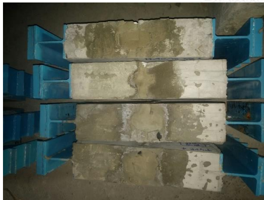
(จ) หลังจากนอนจริงเก่าที่แข็งตัวแล้ว ยิงวัสดุยาแนวกันน้ำซีมบนโคมเส้นลวดร่อนที่รอยต่อ
