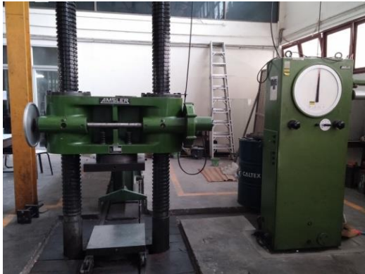
รูปที่ ค. 5 เครื่อง AMSLER 500ตัน ที่ใช้ในการผ่าแยกคอนกรีต
