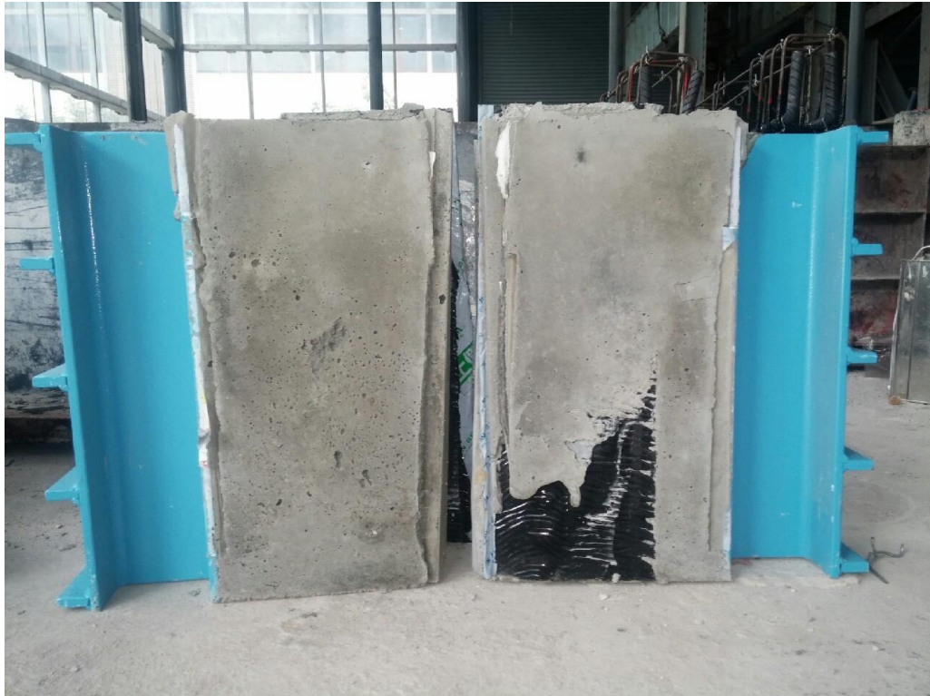
รูปที่ 4.8 แสดงรูปแบบของรอยต่อและวัสดุที่ใช้ในการกันน้ำซึมผ่านประเภทที่ 3
