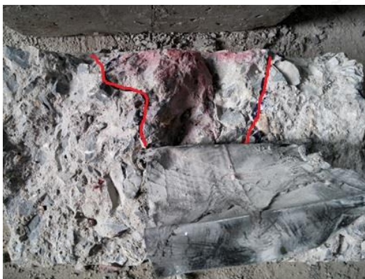
รูปที่ ค. 7 ผลการผ่าแยกของตัวอย่างคอนกรีตที่ใช้ยางบิวทิลไม่พบน้ำรั่วซึมที่รอยต่อ (ทิศทางการให้แรงดันน้ำ จากบนลงล่างของตัวอย่างทดสอบ)
