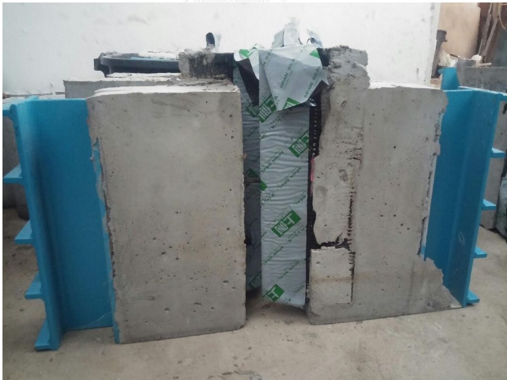
รูปที่ 4.9 แสดงรูปแบบของรอยต่อและวัสดุที่ใช้ในการกันน้ำซึมผ่านประเภทที่ 6
