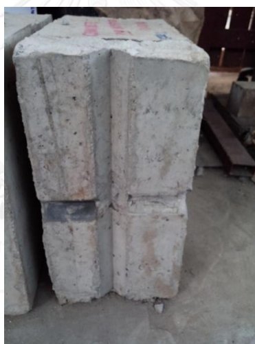
(ค) วางกระดาษที่รอยต่อและเทคอนกรีตส่วนที่เหลือจนเต็มแบบหล่อ
