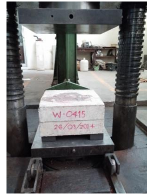
รูปที่ ค. 5 เครื่อง AMSLER 500ตัน ที่ใช้ในการผ่าแยกคอนกรีต
