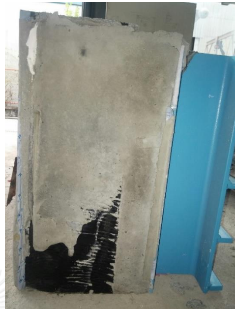
รูปที่ ๑. 5 คอนกรีตไม่หุ้มแผ่นยางบิวไทล์ ในรูปแบบรอยต่อประเภทที่ 3
