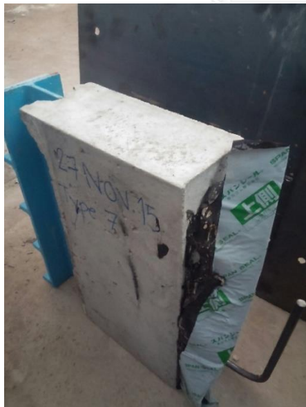
รูปที่ ๑. 12 คอนกรีตไม่หุ้มแผ่นยางบิวทิล ในรูปแบบรอยต่อประเภทที่ 7
