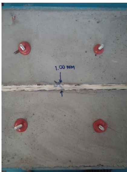
รูปที่ ๕. การเคลื่อนที่แบบสัมผัสพัทธ์ที่รอยต่อของตัวอย่างประเภทที่ ๘
