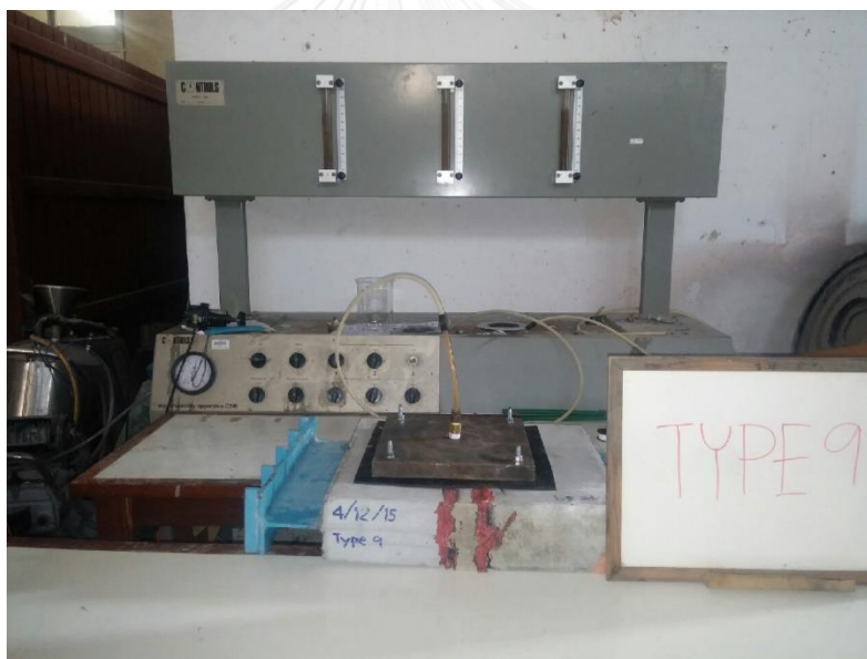
รูปที่ ข. 5 การทดสอบการกั้นน้ำซึมผ่านประเภทที่ 9
