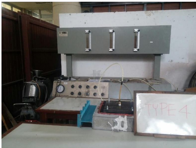
รูปที่ ช. 2 การทดสอบการกั้นน้ำซึมผ่านประเภทที่ 4
