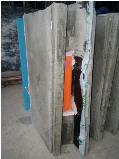
รูปที่ ๑. 5 คอนกรีตไม่หุ้มแผ่นยางบิวไทล์ ในรูปแบบรอยต่อประเภทที่ 3
