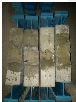
(ค) หลังจากคอนกรีตแข็งตัว วางเหล็ก DB12 ผ่าน Wire rope loop
