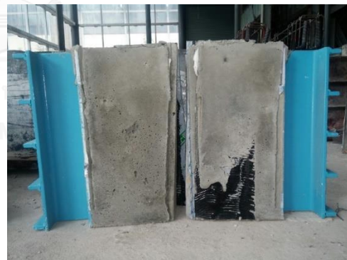
(ง) หลังจากคอนกรีตแข็งตัวแล้ว ถอดแบบเหล็กออก เผยให้เห็นแผ่นยางบิวไทล์
