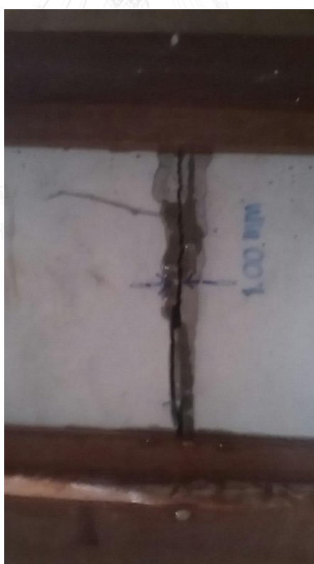
รูปที่ ช. 1 การทดสอบการกันน้ำซึมผ่านประเภทที่ 1
