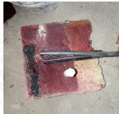
รูปที่ ค. 6 ผลการผ่าแยกของตัวอย่างคอนกรีตที่ใช้ยางโพลีไวนิลคลอไรด์ที่รอยต่อ (ทิศทางการให้แรงดันน้ำ จากบนลงล่างของตัวอย่างทดสอบ)
