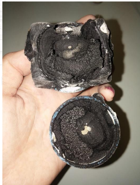
รูปที่ ข. 2 ลักษณะการวิบัติของยางบิวไทล์กับวัสดุอ่อนจริงเกร้าท์เมื่อรับแรงดึง
