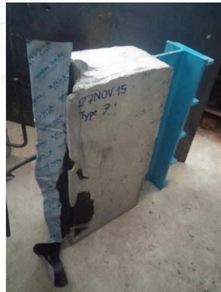
รูปที่ ๑. 12 คอนกรีตไม่หุ้มแผ่นยางบิวทิล ในรูปแบบรอยต่อประเภทที่ 7
