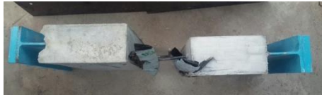
(ก) รายละเอียดรูปแบบรอยต่อประเภทที่ 3
