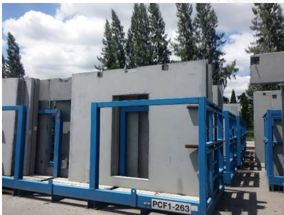
รูปที่ ง. 6 การเก็บและรอกขนส่งแผ่นคอนกรีตหล่อสำเร็จ
