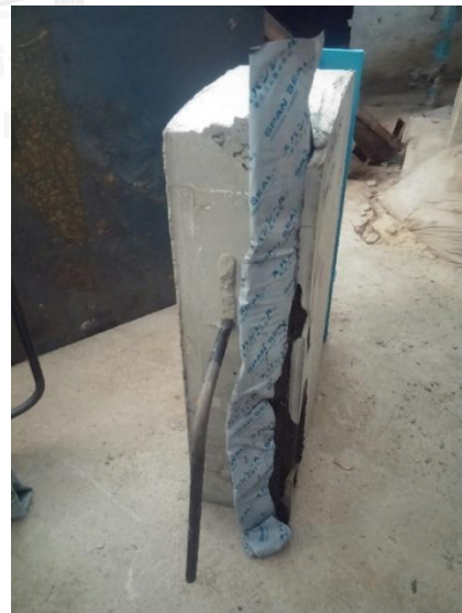
รูปที่ ๑. 10 คอนกรีตไม่หุ้มแผ่นยางบิวทิล ในรูปแบบรอยต่อประเภทที่ 6
