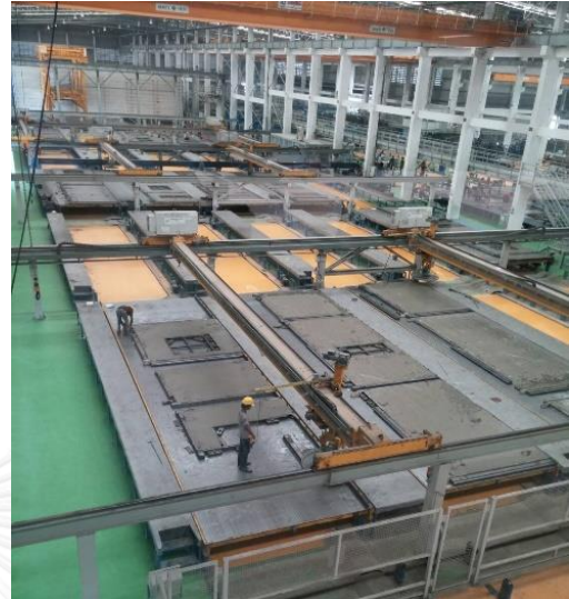
รูปที่ ง. 5 วางเหล็กเสริมและเทคอนกรีตแผ่นคอนกรีตหล่อสำเร็จ
