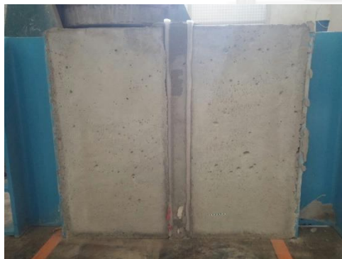
(ง) ติดวัสดุโฟมเส้นอุดร่องในร่องรอยต่อ
