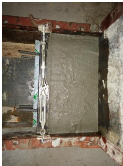
(ข) เทคอนกรีตครึ่งหนึ่งของตัวอย่างทดสอบ
