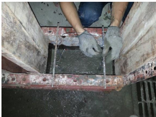
(ก) เทคอนกรีตครึ่งหนึ่งของตัวอย่างทดสอบ
