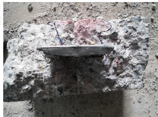
รูปที่ ค. 7 ผลการผ่าแยกของตัวอย่างคอนกรีตที่ใช้ยางบิวทิลไม่พบน้ำรั่วซึมที่รอยต่อ (ทิศทางการให้แรงดันน้ำ จากบนลงล่างของตัวอย่างทดสอบ)
