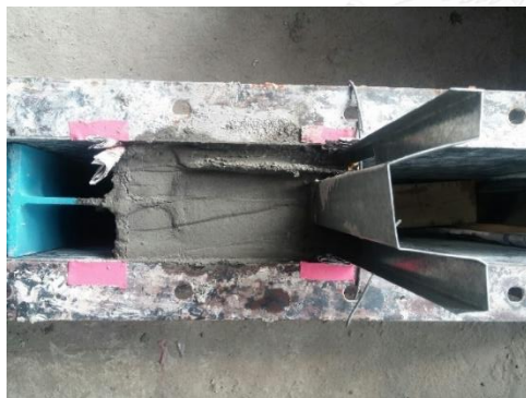
(ง) หลังจากคอนกรีตแข็งตัวแล้ว ถอดแบบเหล็กออก เผยให้เห็นแผ่นยางบิวไทล์
