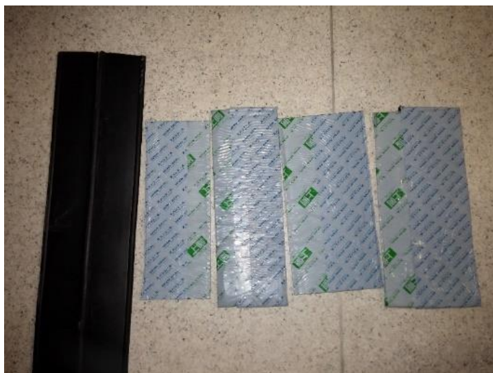
รูปที่ 3.14 แผ่นยางโพลีเอทิลีนคลอไรด์ แผ่นยางบิวทิล W-0615, W-0415, W-0620 และ W-0420
