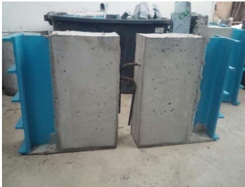
(ค) หลังจากเทคอนกรีตเตรียมเทนอนซริงเกอร์ที่รอยต่อ
