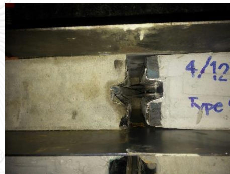
(ค) หลังจากคอนกรีตแข็งตัวแล้ว วางเหล็ก DB12 ผ่าน C-line และเทนอนซิ่งเกอร์ท์
