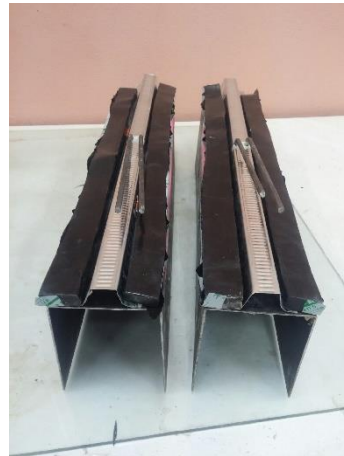
(ข) ติดตั้งยางบิวไทล์ ที่แบบหล่อเหล็ก
