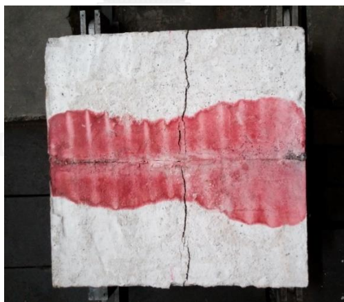
รูปที่ 4.1 พบน้ำรั่วซึมที่บริเวณด้านล่างของตัวอย่างที่ไม่มีแผ่นยาง (ด้านล่างของตัวอย่างทดสอบ)
