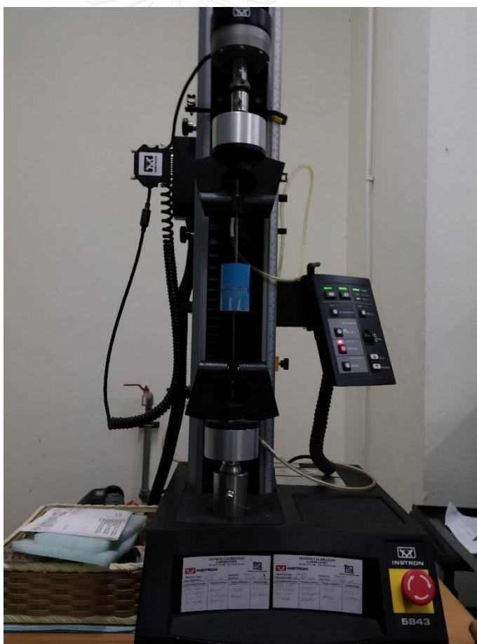
รูปที่ 3.5 เครื่องทดสอบแรงดึง 1000 N
