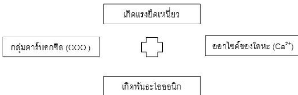
รูปที่ 2.3 การสร้างพันธะยึดเหนี่ยวกันของคอนกรีตและแผ่นยางบิวไทล์ [5]
