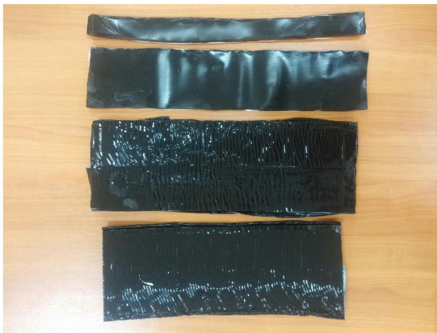
รูปที่ 3.19 ยางบิวไทล์ที่ใช้ในการทดสอบ
