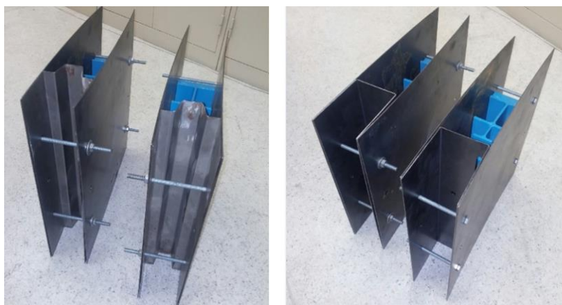
รูปที่ 3.20 แบบหล่อเหล็กขนาด 400x400x100 มิลลิเมตร
