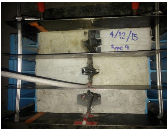
(ค) ติดตั้งโคมเส้นลวดร่อนที่รอยต่อ
