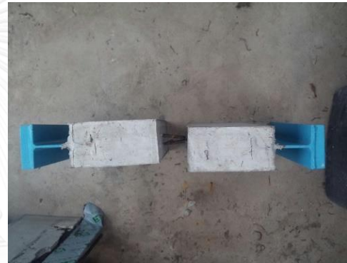
(ค) หลังจากเทคอนกรีตเตรียมเทนอนซริงเกอร์ที่รอยต่อ
