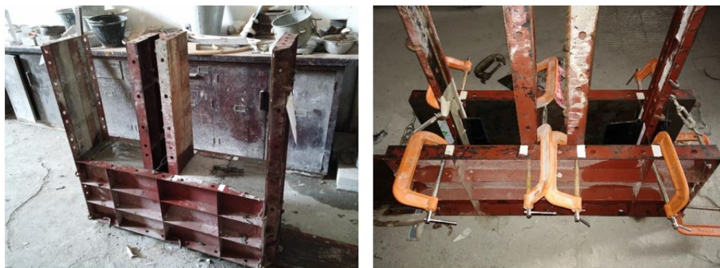
รูปที่ 3.16 แบบหล่อสำหรับตัวอย่างทดสอบการกันน้ำซึมผ่าน
