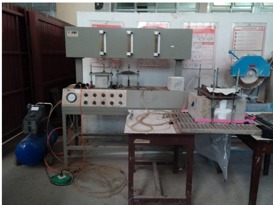
รูปที่ 3.17 แสดงเครื่องอัดน้ำที่พัฒนาให้เหมาะสมกับก้อนตัวอย่าง
