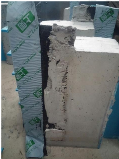
รูปที่ ๑. 10 คอนกรีตไม่หุ้มแผ่นยางบิวทิล ในรูปแบบรอยต่อประเภทที่ 6
