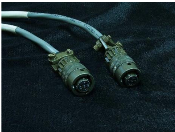
รูปที่ ภาพผนวก-60 สายเชื่อมต่อสัญญาณ Interlock
