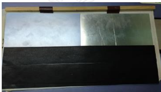
รูปที่ 3-24 ภาพถ่ายของการจัดวางบันทึกภาพ เทปผ้า และแผ่นอะลูมิเนียมในแนวด้านหน้า
