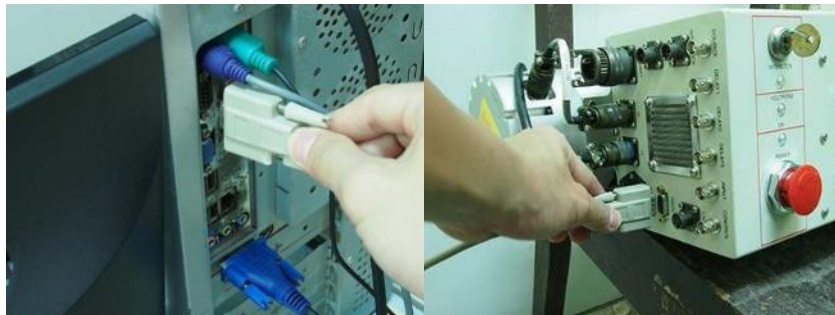
รูปที่ ภาพผนวก-63 การเชื่อมต่อสายสัญญาณชนิด RS232 กับ PC
