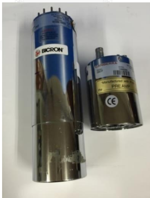
รูปที่ 3-5 หัววัดรังสีแกมมาชนิดซินทิลเลชัน โซเดียมไอโอไดด์ (ทัลเลียม)
