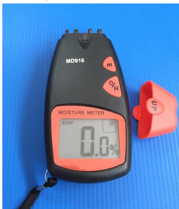
รูปที่ 3-14 เครื่องวัดความชื้น รุ่น MD916
