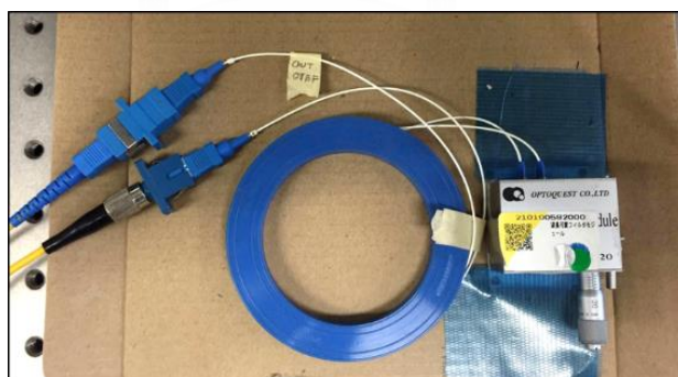
รูปที่ 3.15 ตัวกรองสัญญาณเฉพาะย่านความถี่แสงแบบปรับค่าได้ของบริษัท OPTOQUEST
