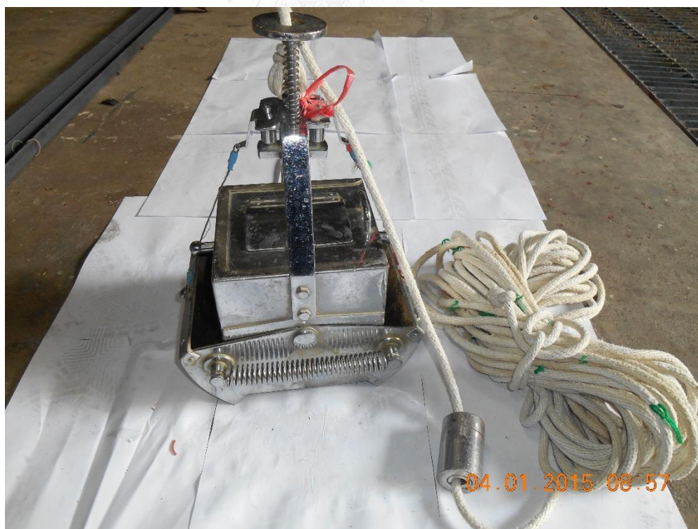
ภาพที่ ข-1 เครื่องตักหน้าดิน (Birge-Ekman grab sampler) ที่ใช้ในการสำรวจ
