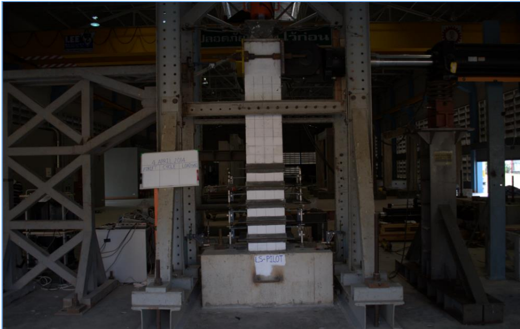
รูปที่ 5.1 แสดงตัวอย่างเสาก่อนทำการทดสอบ
