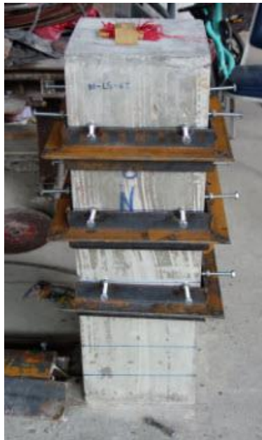
รูปที่ 3.8 เสาค RC-LS ติดตั้งเหล็กรูปตัวทีที่ขนาด 100x100x5.5x8 mm
