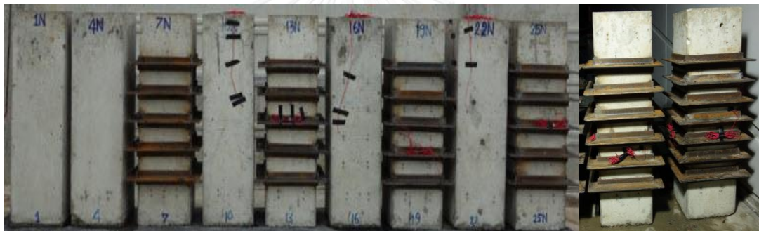
รูปที่ 3.4 ตัวอย่างเสาทดสอบหน้าตัด 0.25x0.25 เมตร สูง 0.75 เมตร จำนวน 11 ตัวอย่าง
