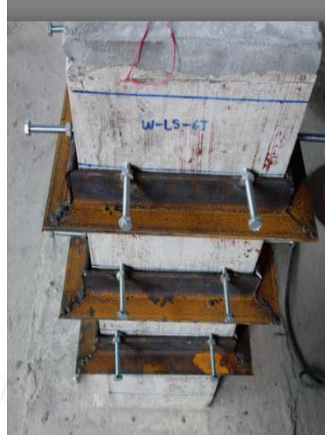
รูปที่ 3.8 เสาค RC-LS ติดตั้งเหล็กรูปตัวทีที่ขนาด 100x100x5.5x8 mm
