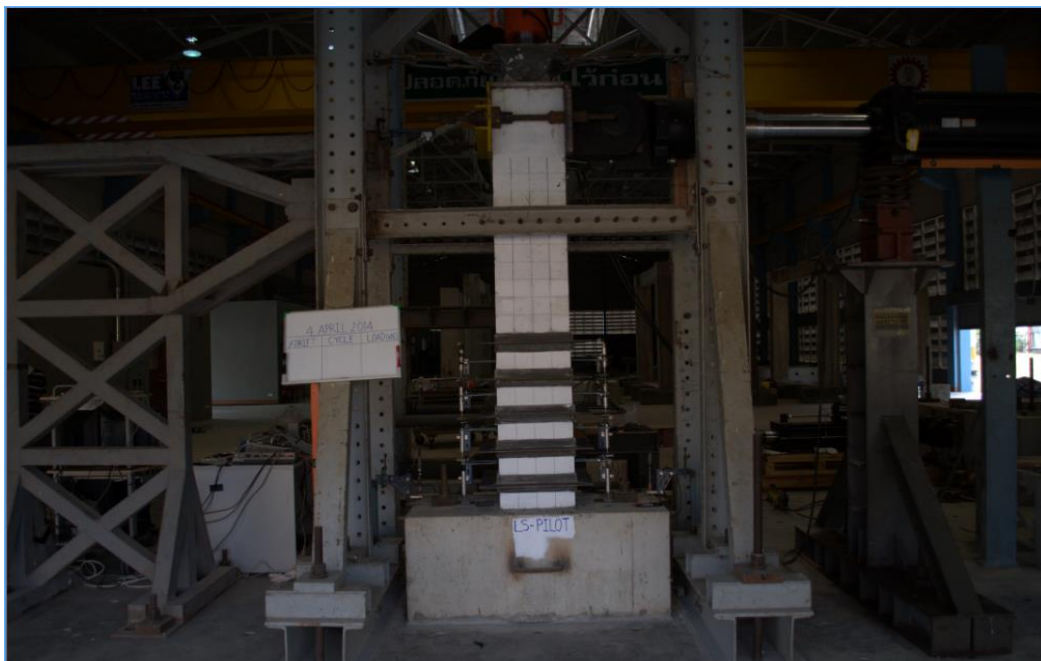
รูปที่ 1.1 ตัวอย่างเสาทดสอบโอบรัดด้วยกรอบเหล็กรูปตัวที
