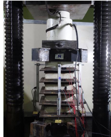
(ข) การติดตั้งเสาทดสอบ
