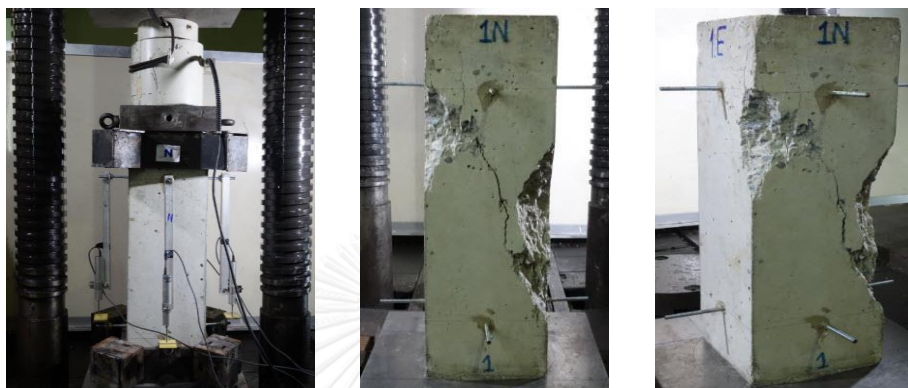
(ก) เสาก่อนทดสอบ (ข) หลังทำการทดสอบด้าน N (ค) หลังทำการทดสอบด้าน NE
