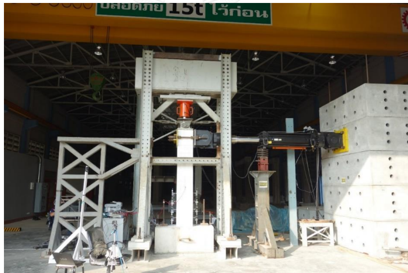
รูปที่ 3.19 เสาตัวอย่างติดตั้งพร้อมทำการทดสอบ
