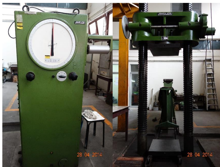
รูปที่ 3.14 Universal Testing Machine (แรงกดสูงสุด 500 ตัน)
