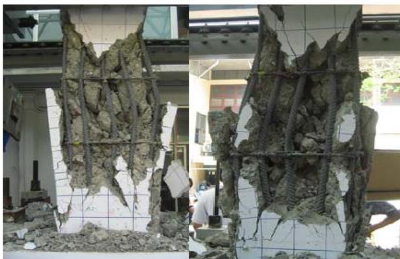
รูปที่ 2.2 การวิบัติของเสาที่ไม่มี การต่อทาบ (C/9/300) (ครรชนะ รัตนพงศ์ พ.ศ. 2553)
