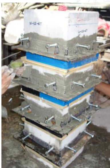
รูปที่ 3.9 ใช้ซีเมนต์เกรทอุดช่องว่างระหว่างเสากับ เหล็กรูปตัวที (RC-LS)
