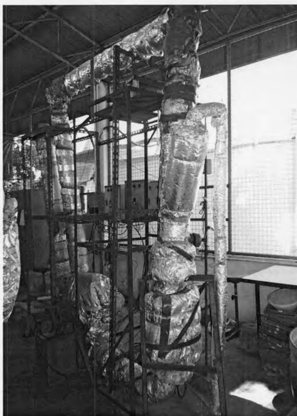
รูปที่ ข.1 เครื่องอบแห้งแบบฟลูอิดไชน์เบด
