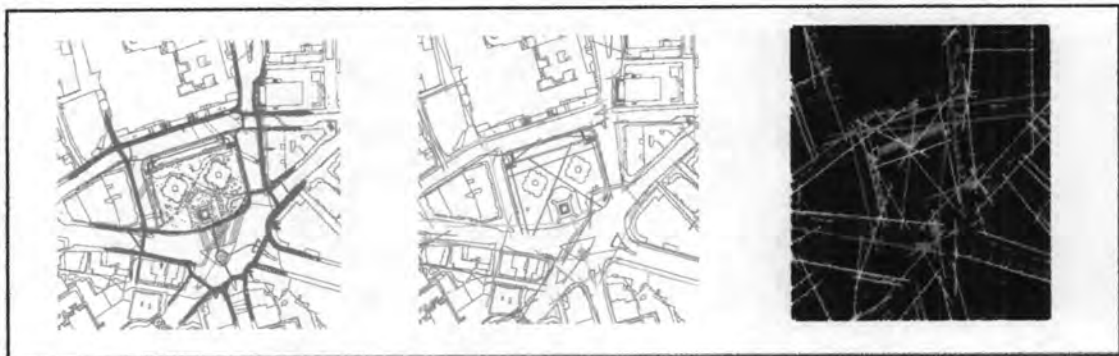
ภาพที่ 2.08: ภาพการสำรวจอัตราการสัญจรผ่าน แล้วนำมาเปรียบเทียบกับ การใช้โปรแกรม Space Syntax ซึ่งได้ผลสำรวจตรงกัน (ที่มา: Space Syntax Laboratory, 2006)
