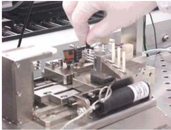
รูปที่ ก.7 ปลดตัวยึดชุดหัวอ่านออก เพื่อเอาชุดหัวอ่านออกจากเครื่องวัด Gramload
