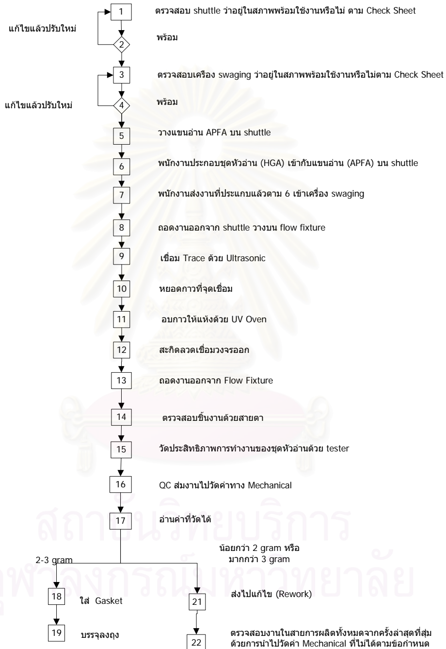
รูปที่ 3.1 แผนภาพกระบวนการผลิตรวม
