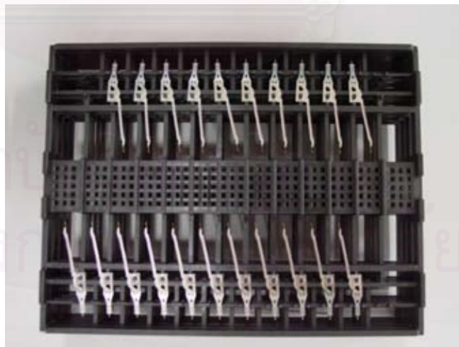
รูปที่ 5.1 ชุดหัวอ่าน (HGA) ที่ใช้ในกระบวนการประกอบชุดหัวอ่านสำเร็จ
