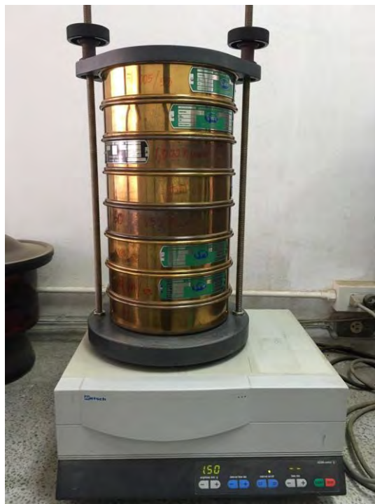
รูป 2.6 การคัดแยกขนาดตะกอนแบบแห้ง โดยใช้เครื่อง Retch
