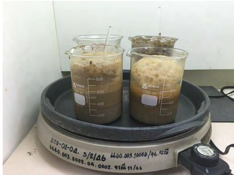
รูป 2.7 การทำความสะอาดตะกอนด้วยไฮโดรเจนเปอร์ออกไซด์ เพื่อกำจัดสารอินทรีย์
