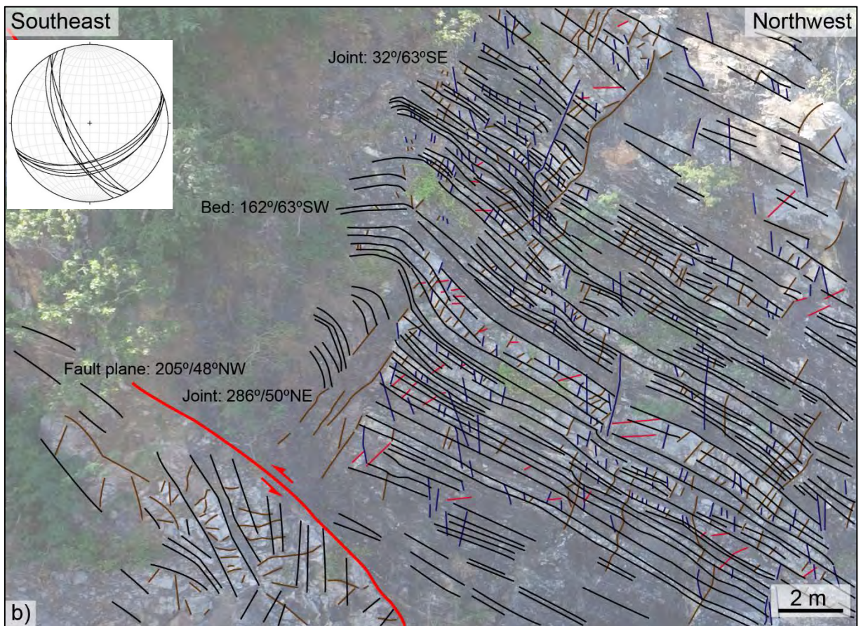
รูปที่ 4.5 (a) รูปบนพบการคดโค้งของชั้นหินและรอยเลื่อน (b) รูปล่างแสดงการกำหนดตำแหน่งข้อมูลในตาข่ายมิติ สเตอร์ีโอกราฟิกชนิดพื้นที่เท่า การวางตัวของชั้นหิน (เส้นสีดำ) รอยเลื่อนย้อน (เส้นสีแดง) รอยแตกที่ตั้งฉากกับชั้นหิน (เส้นสีน้ำตาล) รอยแตกที่ทำมุมกับชั้นหิน (เส้นสีชมพูและเส้นสีน้ำเงิน) มองไปทางทิศตะวันตกเฉียงใต้
