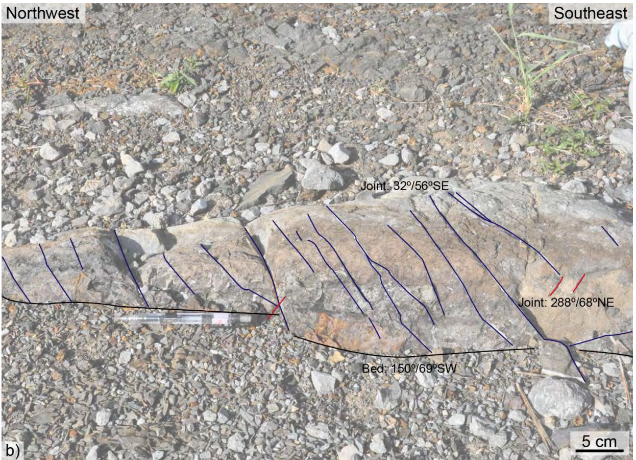
รูปที่ 4.16 (a) รูปบนพบรอยแตกพร้อม (b) รูปล่างแสดงการวางตัวของชั้นหิน (เส้นสีดำ) รอยแตกพร้อมที่ทำมุมกับชั้นหิน (เส้นสีชมพูและเส้นสีน้ำเงิน) มองไปทางทิศตะวันออกเฉียงเหนือ
