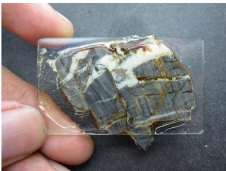
รูป 2.5 แสดงตัวอย่างแผ่นหินที่ยึดติดกับแผ่นสไลด์ สำหรับนำไปขัดเพื่อทำแผ่นหินบาง
