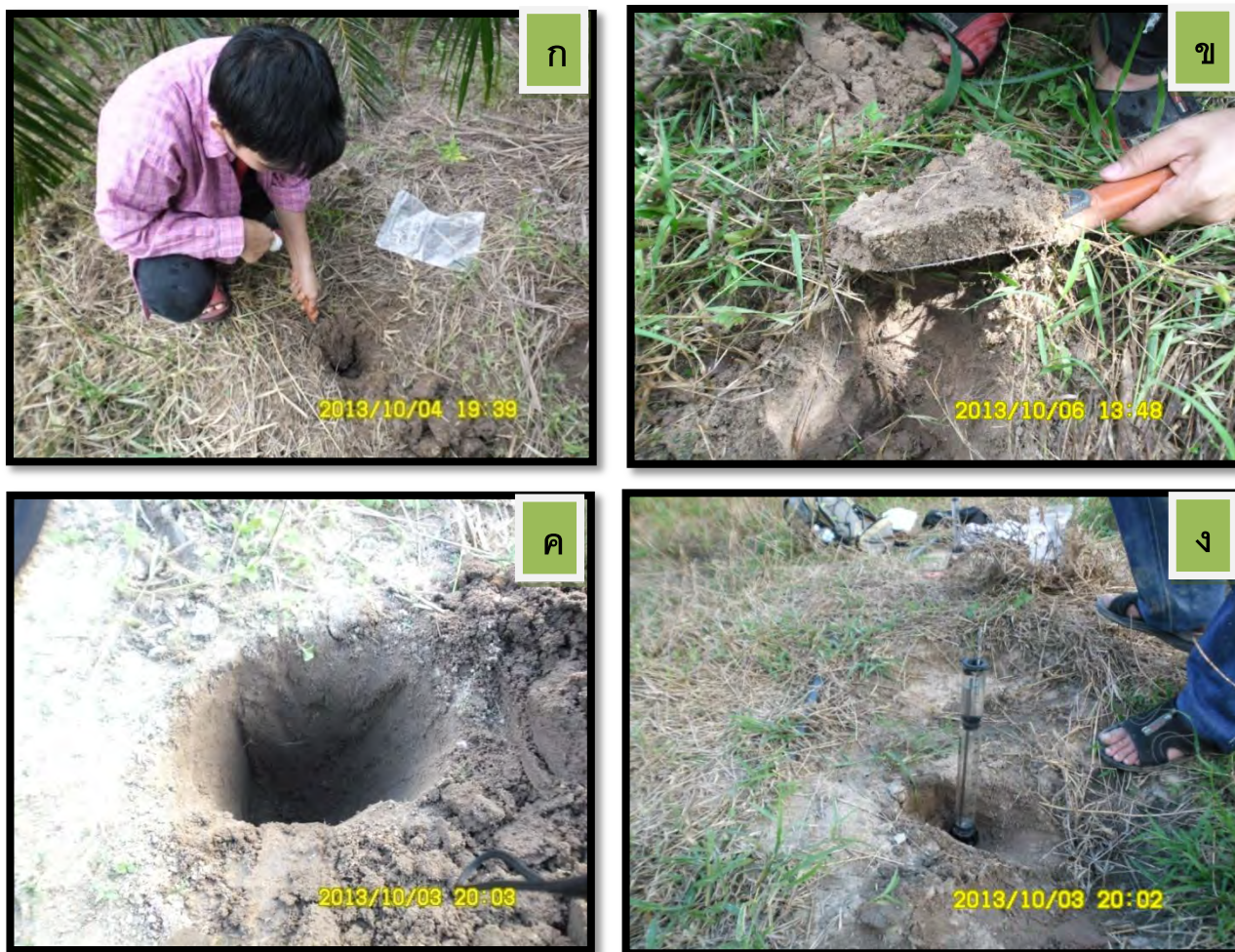
รูปที่ 4.1 ภาพการเก็บตัวอย่างดินในภาคสนามและวัดค่าอัตราการซึม
