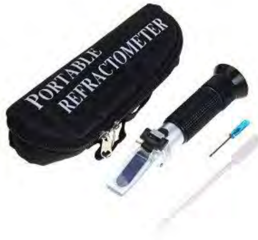
รูปที่ ก.2 เครื่องวัดความเค็ม(Salinity refractometier) รุ่น RHS-28/ATS
