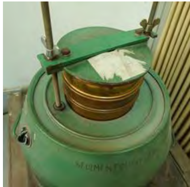
รูปที่ 2.3 การทำ Dry sieve (ซ้่าย) และทรายขนาด 0.6 - 0.85 มม. (ขวา)
