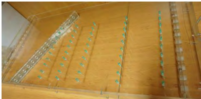
รูปที่ 2.4 จุดเก็บตัวอย่าง โดยใช้เข็มฉีดยา
