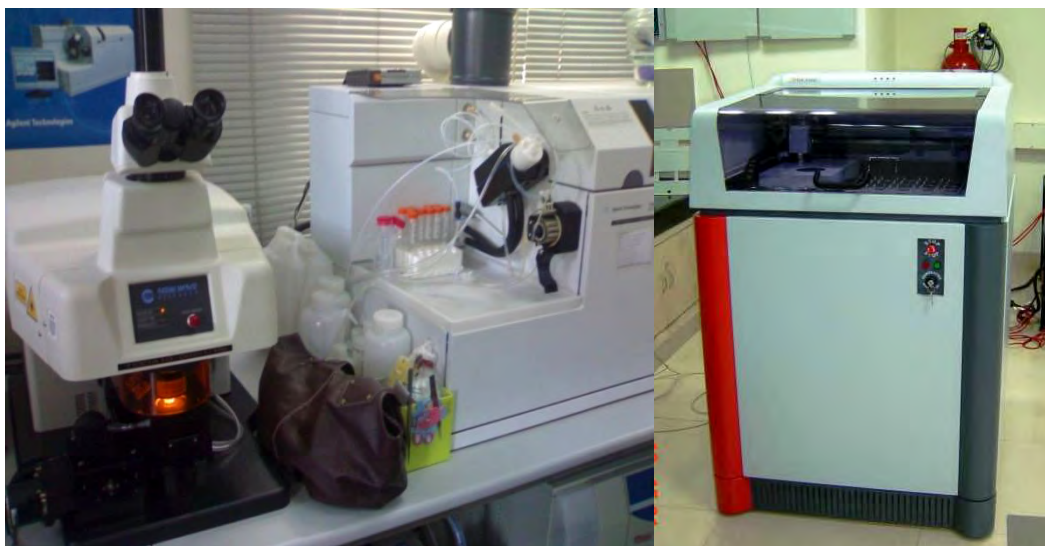
รูป 1.3 เครื่อง Inductively Coupled Plasma – Mass Spectrometry (ICP-MS) (ซ้าย) และเครื่อง X-ray fluorescence spectrometry (XRFs) (ขวา)
