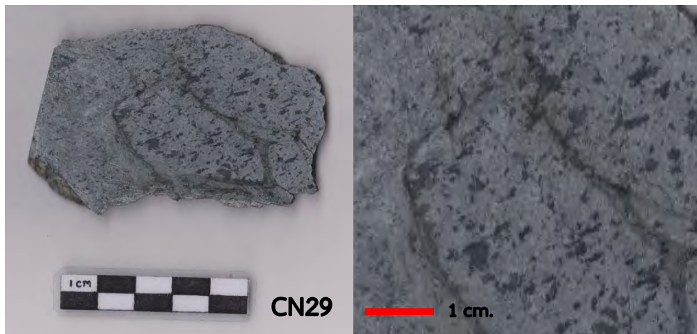
รูป 3.33 ภาพถ่ายแผ่นหินขัดหน้าเรียบของหินโอลิวีนไพรอกซีน (ซ้ายเป็นภาพแบบกว้าง และขวาเป็นภาพแบบขยาย) แสดงลักษณะสามารถมองเห็นผลึกได้ด้วยตาเปล่า (phaneritic texture) ขนาดผลึกเล็กถึงปานกลาง มีลักษณะเป็นเนื้อดอก (porphyritic texture) ประกอบด้วยแร่สีดำ คือ แร่โอลิวีน เป็นแร่ดอก และแร่สีเทาดำ คือแร่ไพรอกซีนเป็นเนื้อพื้น ตัวอย่าง CN29 พิกัดภูมิศาสตร์ ลองจิจูด 100°44'54.585"E ละติจูด 19°15'10.722"N
