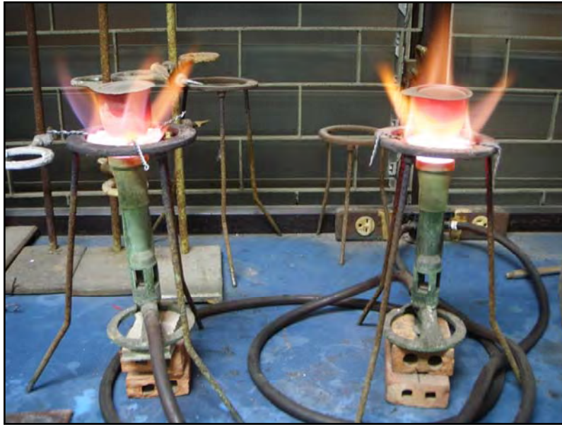
รูปที่ 2.4 แสดง crucible ที่เผาด้วย ตะเกียงบุนแสลง (Bunsen Burner)
