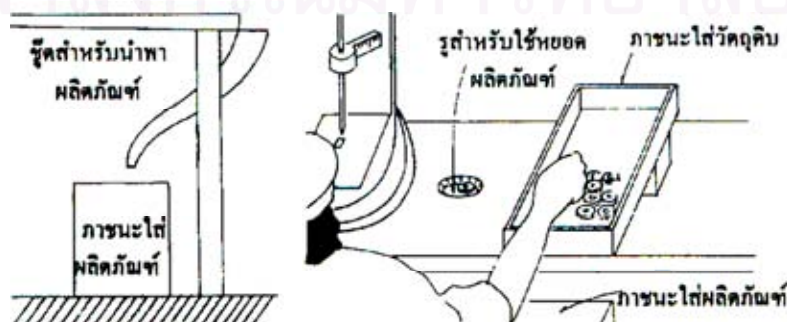
รูปที่ 2.9 อุปกรณ์นำทิ้งชิ้นงานที่เสร็จแล้วลงภาชนะบรรจุ
