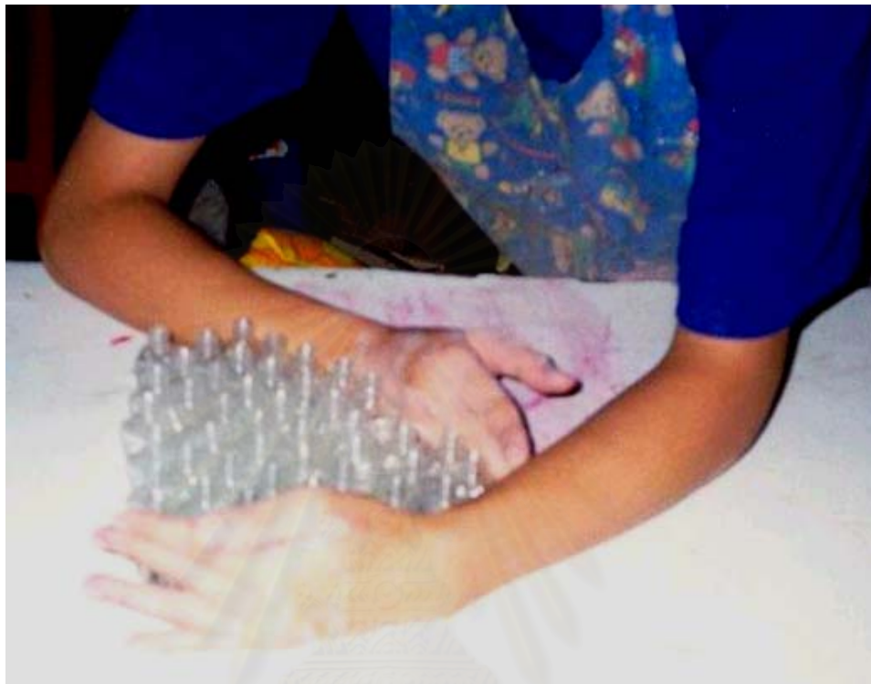
รูปที่ 4.13ก การเคลื่อนย้ายขวดในขั้นตอนการบรรจุน้ำทาเล็บ
