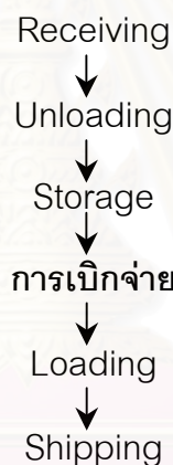
รูปที่ 3.9 แสดงกิจกรรมที่เกิดขึ้นในการรับสินค้าจาก โรงงาน ถึงการจัดส่งให้กับลูกค้า
