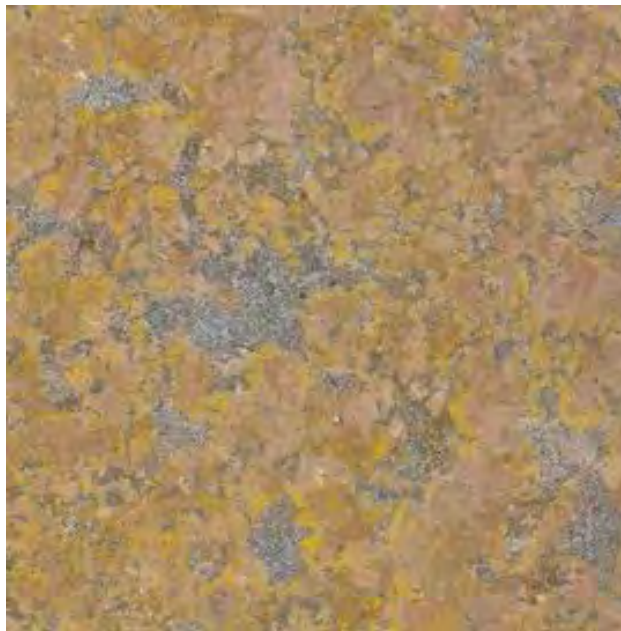
รูปที่ 2.13 แสดงภาพสแกนแผ่นหินที่ทำการย้อมสี เพื่อนำไปศึกษา modal analysis
