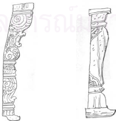
ภาพที่ 3.51 ตัวอย่างลักษณะคันทวยแบบ ทวยแฝง
