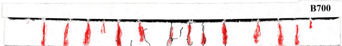
รูปที่ 5.82 คราบแคลเซียมคาร์บอเนตและรอยแตกร้าวที่เกิดขึ้นที่น้ำหนักกระทำ 106.42 กิโลนิวตัน และมีการโก่งตัว 10.17 มิลลิเมตร ของคาน B700
