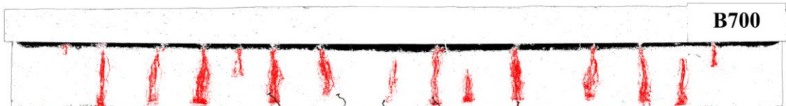
รูปที่ 5.79 คราบแคลเซียมคาร์บอเนตและรอยแตกร้าวที่เกิดขึ้นที่น้ำหนักกระทำ 45.40 กิโลนิวตัน และมีการโคงตัว 2.52 มิลลิเมตร ของคาน B700
