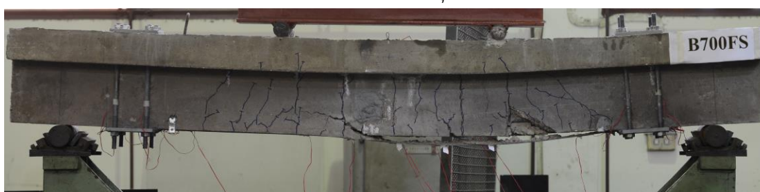
รูปที่ 5.125 รูปถ่ายแสดงการวิบัติของคาน B700FS ที่สอดคล้องกับรูปที่ 5.124
