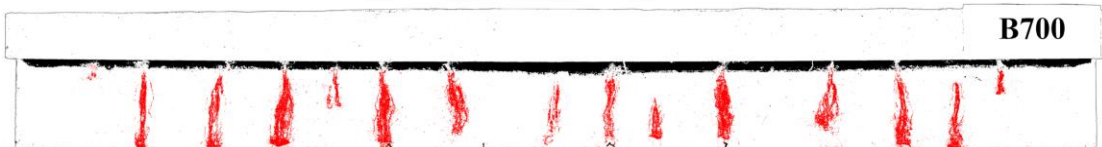
รูปที่ 5.78 คราบแคลเซียมคาร์บอเนตและรอยแตกร้าวที่เกิดขึ้นที่น้ำหนักกระทำ 27.52 กิโลนิวตัน และมีการโคงตัว 1.33 มิลลิเมตร ของคาน B700
