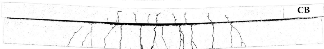
รูปที่ 5.72 รอยแตกร้าวที่เกิดขึ้นที่น้ำหนักกระทำ 139.11 กิโลนิวตัน และมีการโก่งตัว 43.7 มิลลิเมตร ของคานควบคุม CB
