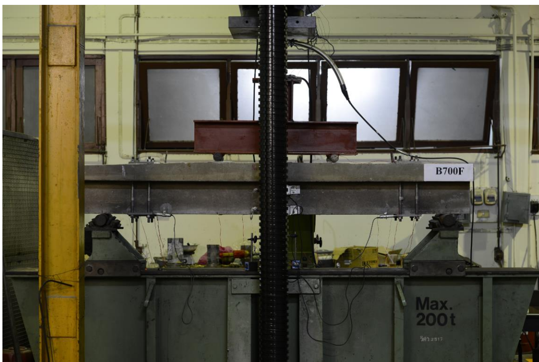
รูปที่ 5.94 รูปการทดสอบคานคอนกรีตเสริมเหล็กรูปตัวทีที่เผาไฟที่อุณหภูมิระดับ 700 องศาเซลเซียส จากนั้นทำการเสริมกำลังด้วยแผ่นพอลิเมอร์เสริมเส้นใยคาร์บอน B700F
