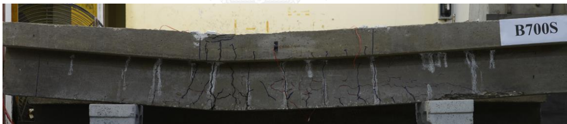
รูปที่ 5.93 รูปถ่ายแสดงการวิบัติของคาน B700S ที่สอดคล้องกับรูปที่ 5.92
