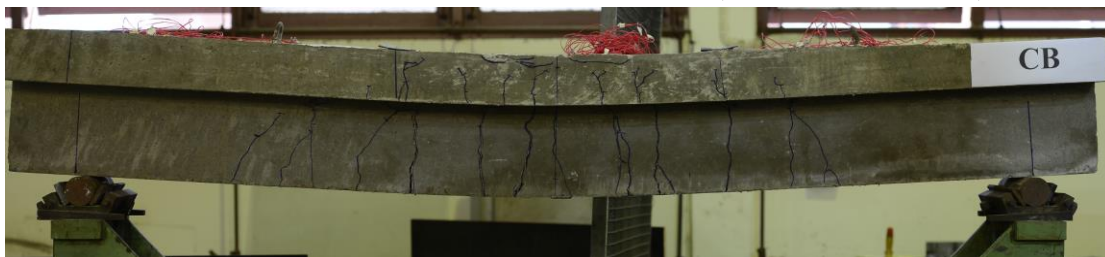
รูปที่ 5.74 รูปถ่ายแสดงการวิบัติของคานควบคุม CB ที่สอดคล้องกับรูปที่ 5.73
