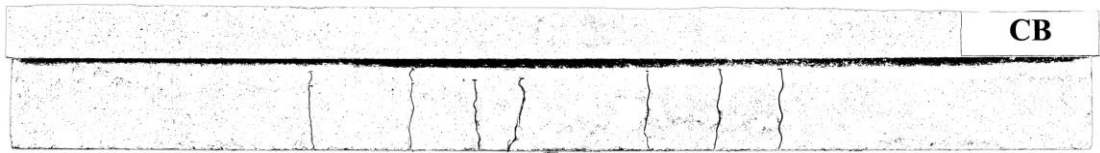
รูปที่ 5.69 รอยแตกร้าวที่เกิดขึ้นที่น้ำหนักกระทำ 70.73 กิโลนิวตัน และมีการโก่งตัว 5.05 มิลลิเมตร ของคานควบคุม CB
