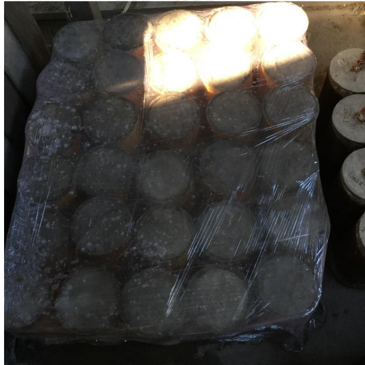
รูปที่ 4.5 การบ่มคอนกรีตทรงกระบอก โดยใช้พลาสติกใส
