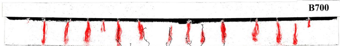
รูปที่ 5.81 คราบแคลเซียมคาร์บอเนตและรอยแตกร้าวที่เกิดขึ้นที่น้ำหนักกระทำ 90.62 กิโลนิวตัน และมีการโก่งตัว 6.60 มิลลิเมตร ของคาน B700
