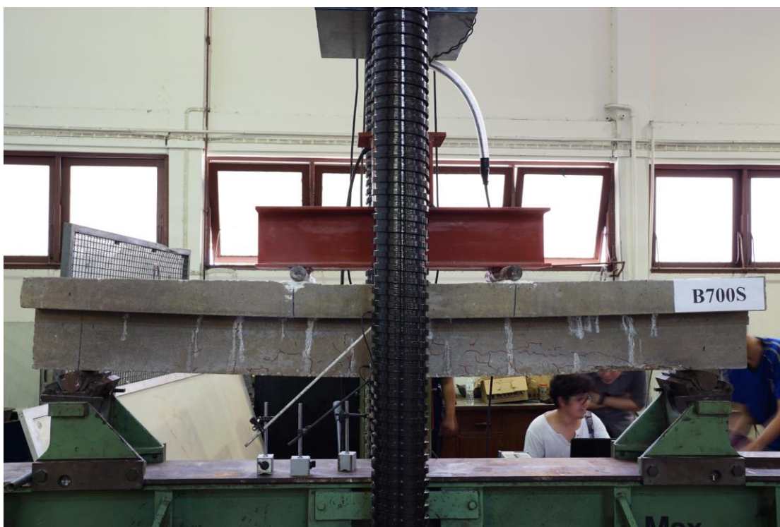
รูปที่ 5.85 รูปการทดสอบคานคอนกรีตเสริมเหล็กรูปตัวที่รับน้ำหนักบรรทุกใช้งานและเผาไฟที่อุณหภูมิระดับ 700 องศาเซลเซียส B700S
