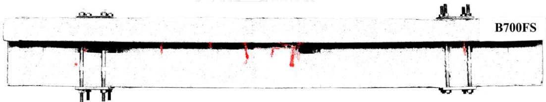
รูปที่ 5.111 คราบแคลเซียมคาร์บอเนตและรอยแตกร้าวที่เกิดขึ้นที่น้ำหนักกระทำ 0 กิโลนิวตัน และมีการโก่งตัว 0 มิลลิเมตร ของคาน B700FS
