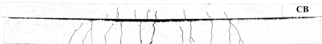
รูปที่ 5.71 รอยแตกร้าวที่เกิดขึ้นที่น้ำหนักกระทำ 116.61 กิโลนิวตัน และมีการโก่งตัว 15.97 มิลลิเมตร ของคานควบคุม CB
