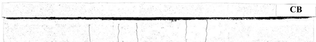
รูปที่ 5.68 รอยแตกร้าวที่เกิดขึ้นที่น้ำหนักกระทำ 48.54 กิโลนิวตัน และมีการโก่งตัว 2.97 มิลลิเมตร ของคานควบคุม CB
