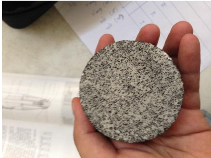
รูปที่ 4.46 หินสำหรับขีดบริเวณผิวคอนกรีตที่ทำการทดสอบ Rebound Hammer
