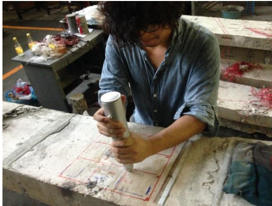
รูปที่ 4.49 ขณะทดสอบแบบไม่ทำลายด้วย Rebound Hammer
