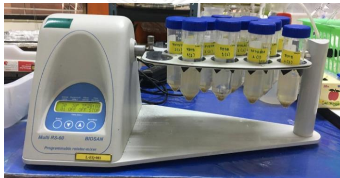
รูปที่ ฉ - 4 การหมุนเพื่อทดสอบการชะละลายด้วยวิธี TCLP
