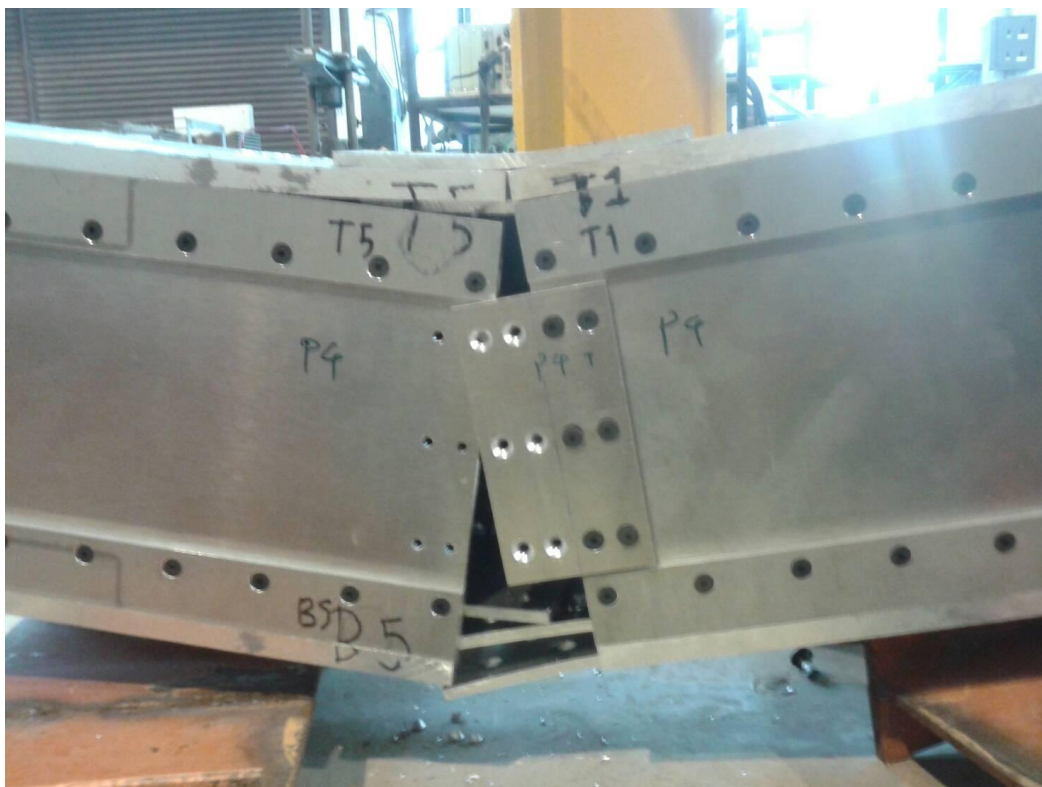
รูปที่ 4.14 การวิบัติของตงทดสอบที่จุดต่อสลักเกลียว
