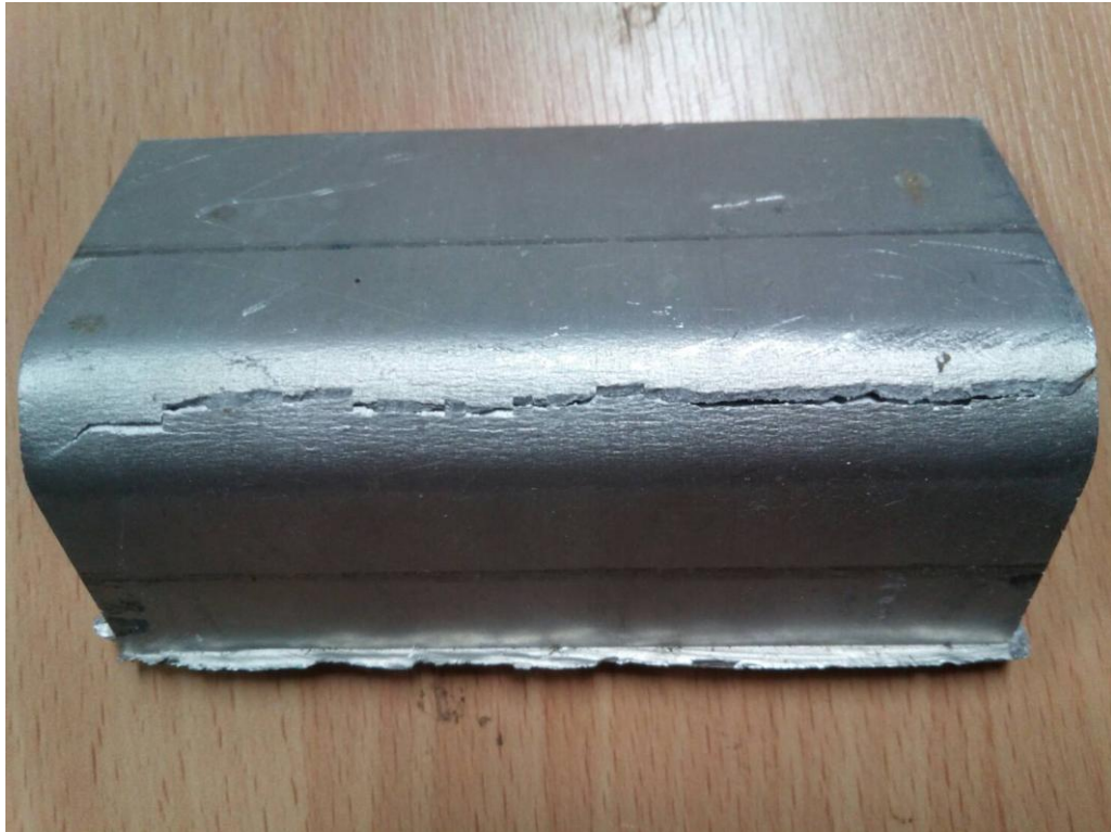
รูปที่ 4.2 ผลการพับอะลูมิเนียม 6061-T651 หนา 6.35 มม. มุมพับ 90 องศา รัศมีมุมพับ 10 มม.
