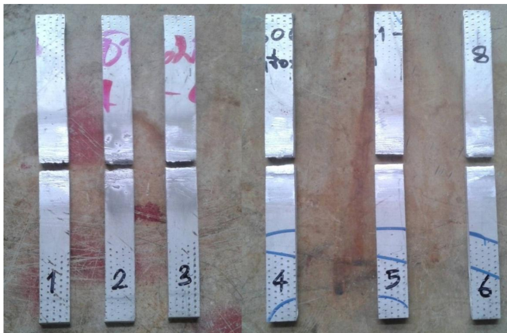
รูปที่ 4.4 ผลทดสอบการดึงอะลูมิเนียม 6061-T651 ที่เชื่อมด้วยลวดเชื่อม ER4043a หมายเลข 1-3 และเชื่อมด้วยลวดเชื่อม ER 5356 หมายเลข 4-6
