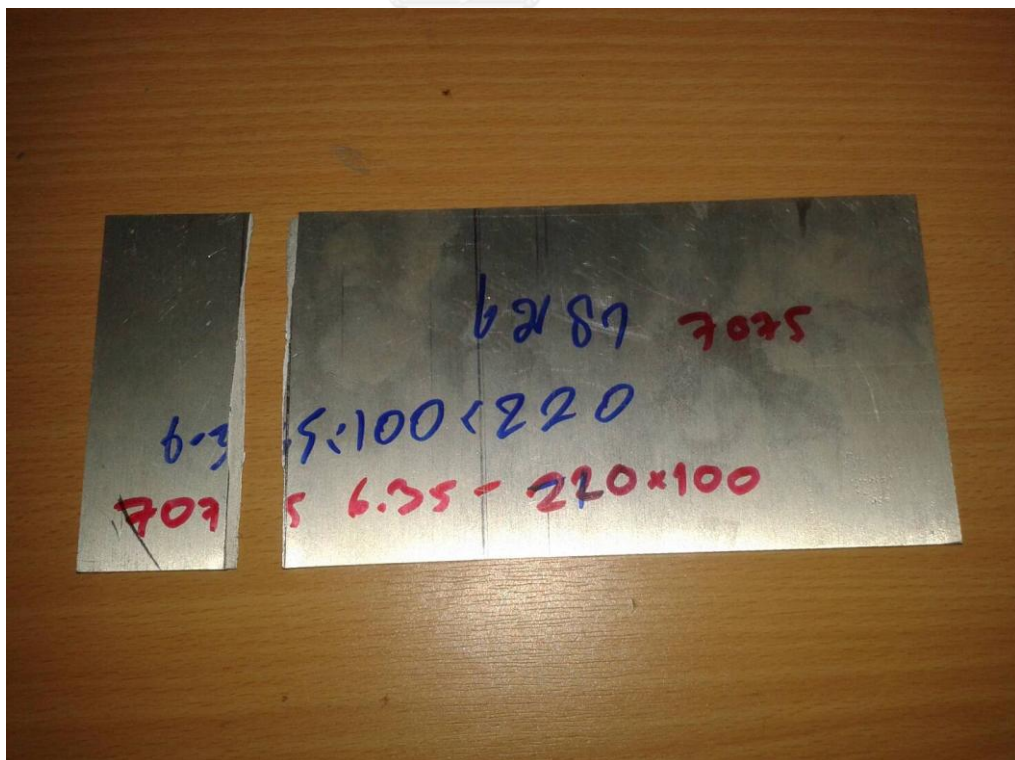
รูปที่ 4.3 ผลการพับอะลูมิเนียม 7075-T651 หนา 6.35 มม. มุมพับ 90 องศา รัศมีมุมพับ 10 มม.
