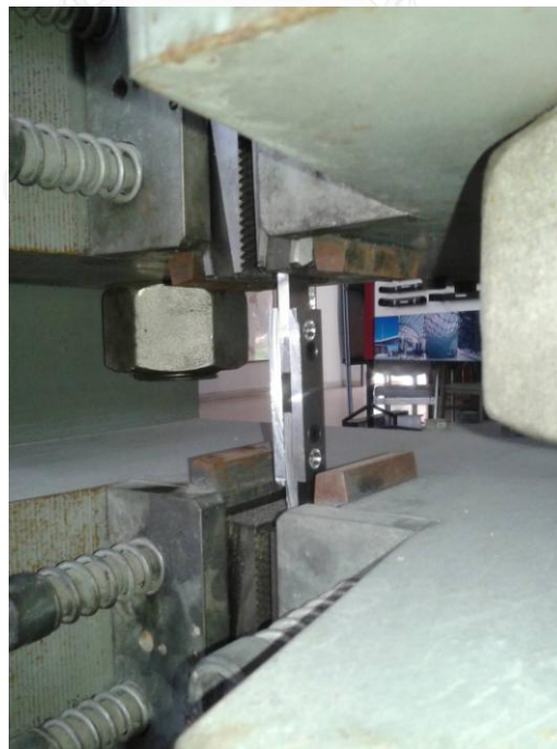
รูปที่ 3.7 การทดสอบกำลังรับแรงเฉือน
