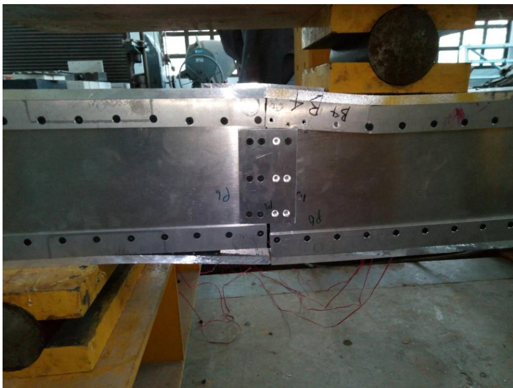
รูปที่ 4.16 การวิบัติของตงเนื่องจากแรงเฉือน
