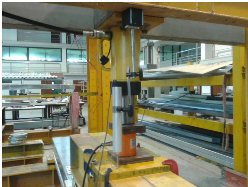
รูปที่ 3.13 การติดโหลดเซลล์และแอลวีดีที
