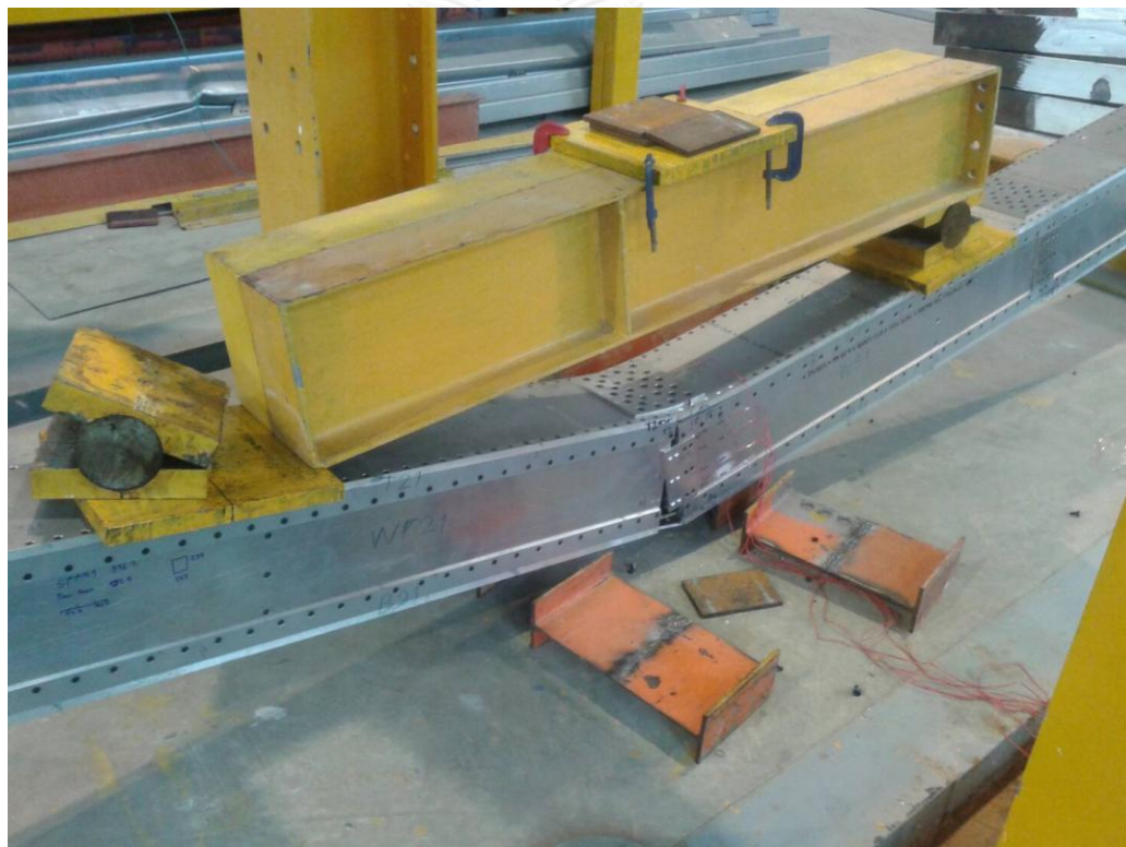
รูปที่ 4.13 การวิบัติของตงทดสอบ
