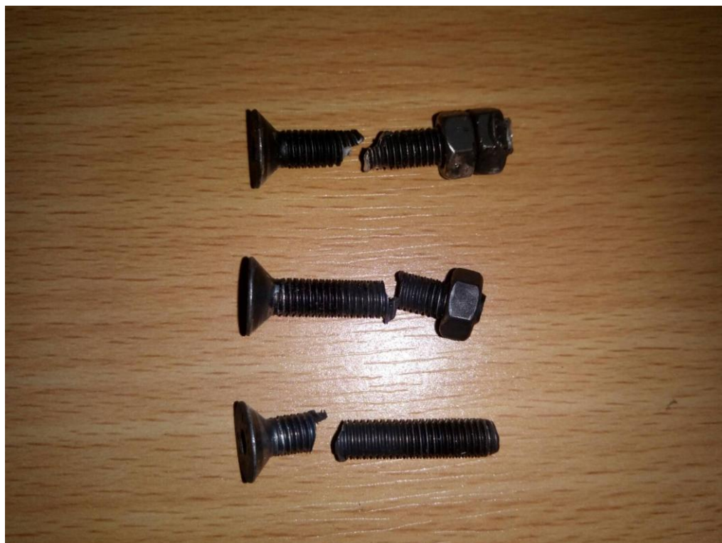
รูปที่ 4.5 ผลการทดสอบค่าหน่วยแรงดึงวิบัติของสลักเกลียวเหล็กชุบดำ เกรด 12.9 ขนาด M5
