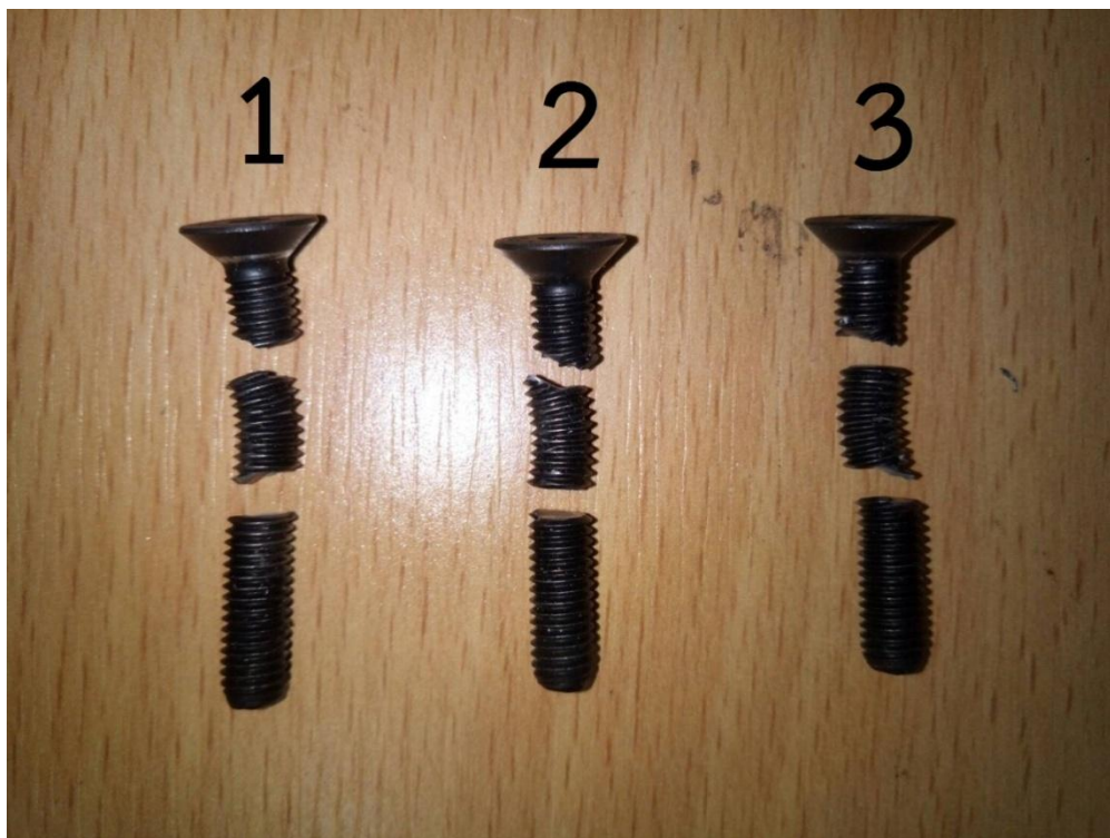
รูปที่ 4.6 ผลทดสอบกำลังรับแรงเฉือน สลักเกลียวเหล็ก ชุบดำ เกรด 12.9 ขนาด M5
