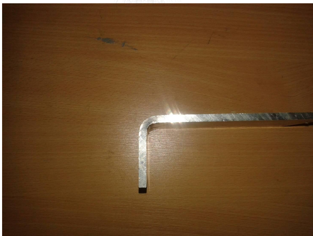
รูปที่ 4.1 ผลการพับอะลูมิเนียม 5083-H112 ทหนา 6.35 มม. มุมพับ 90 องศา รัศมีมุมพับ 10 มม.
