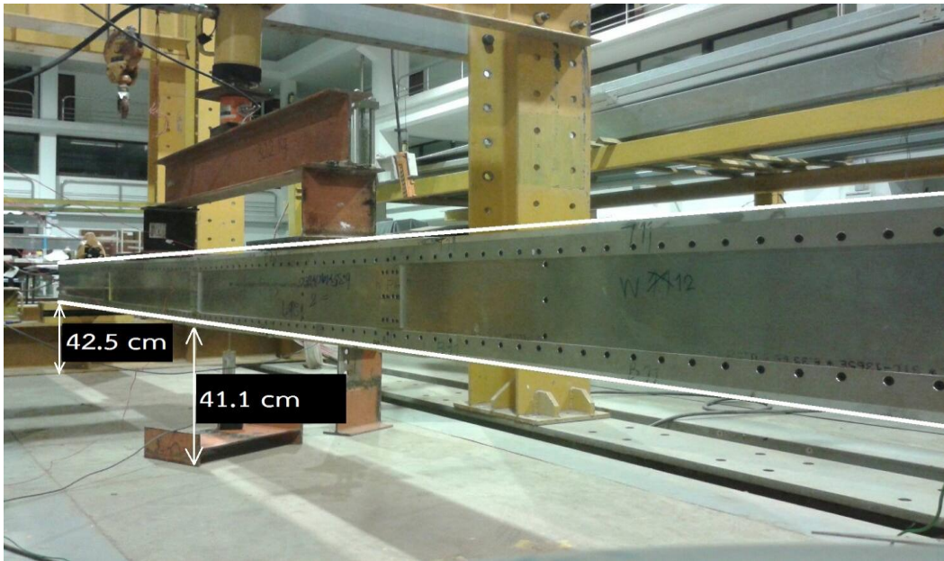
รูปที่ 4.17 การโค้งตัวหลังจากการกดน้ำหนัก 10 ตัน ก่อนทดสอบจริง
