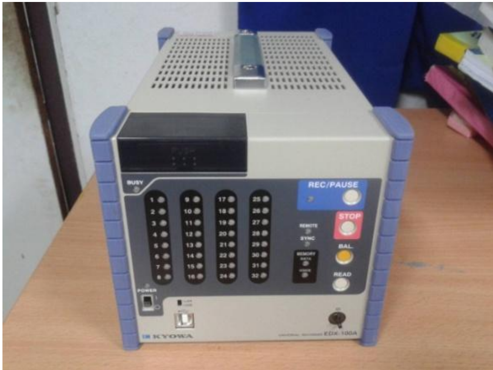
รูปที่ 3.14 อุปกรณ์บันทึกค่าและแปลผลข้อมูล (data logger) ยี่ห้อ Kyowa รุ่น EDX-400A-4H
