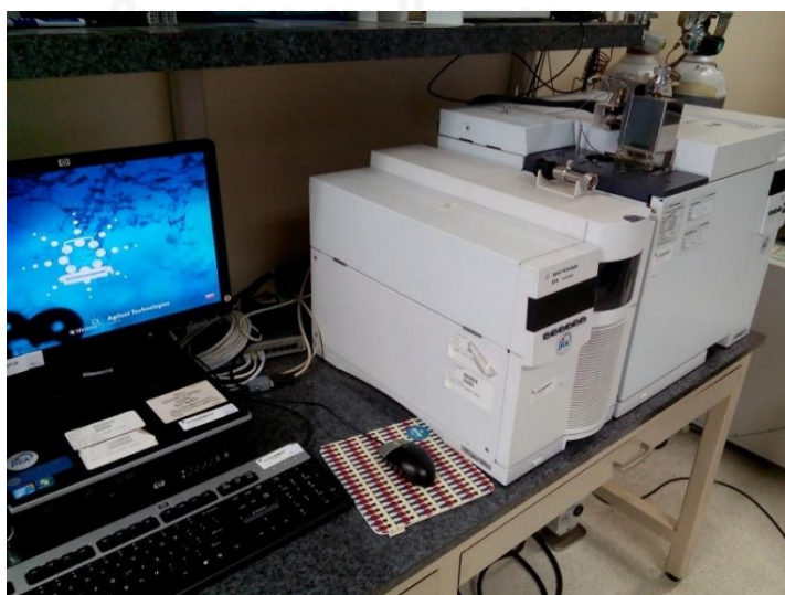
รูปที่ 3.9 เครื่องไพโรไลซิสแก๊สโครมาโทกราฟี-แมสสเปกโตรมิเตอร์
