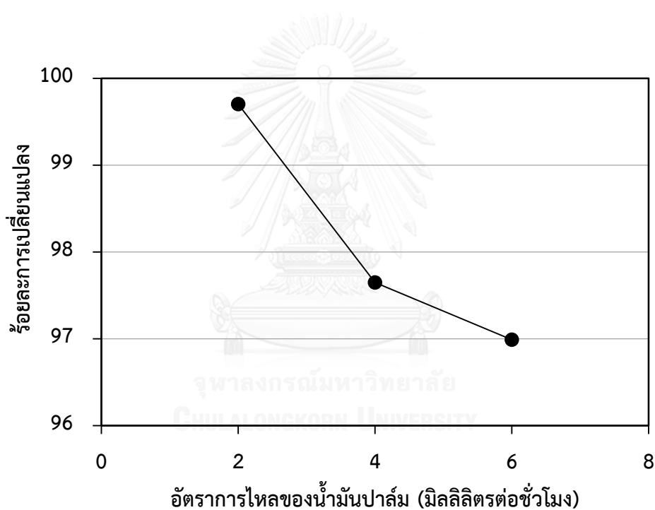
รูปที่ 4.14 ผลต่ออัตราการไหลของน้ำมันปาล์มต่อร้อยละการเปลี่ยนแปลงของไตรกลีเซอไรด์ ในเครื่องปฏิกรณ์แบบช่องจุลภาค ไม่เติมตัวเร่งปฏิกิริยา ที่อุณหภูมิ 450 องศาเซลเซียส
