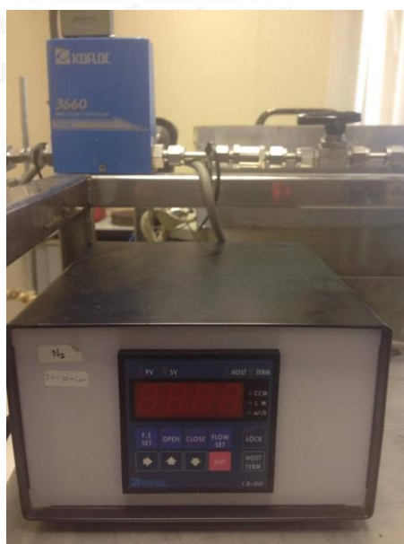
รูปที่ 3.5 เครื่องควบคุมอัตราการไหลของแก๊ส
