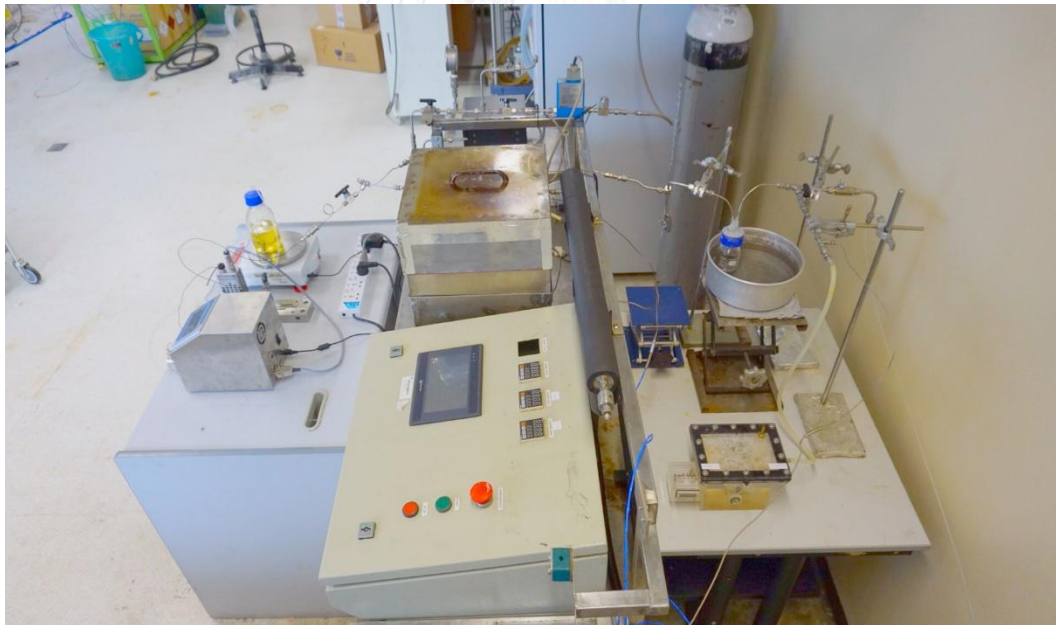
รูปที่ 3.2 เครื่องมือที่ใช้ในการทดลองไพโรไลซิสน้ำมันปาล์ม
